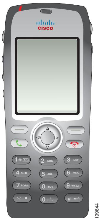
Cisco Unified Wireless IP Phone 7925G および 7926G は、高機能電話機であり、認定 Bluetooth ワイヤレス デバイス (Qualified Device ID (QDID) B014396) です。この電話機は、コンピュータが使用するものと同じワイヤレス LAN を使用して音声によるコミュニケーションを提供するものであり、電話機のコールの発信や受信、保留、転送、会議の開催などが可能です。
