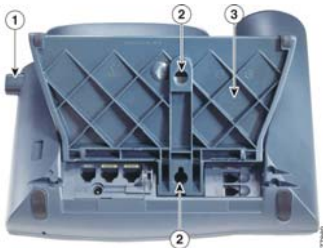
図 3-2 Cisco IP Phone を壁面に取り付けるための部品
