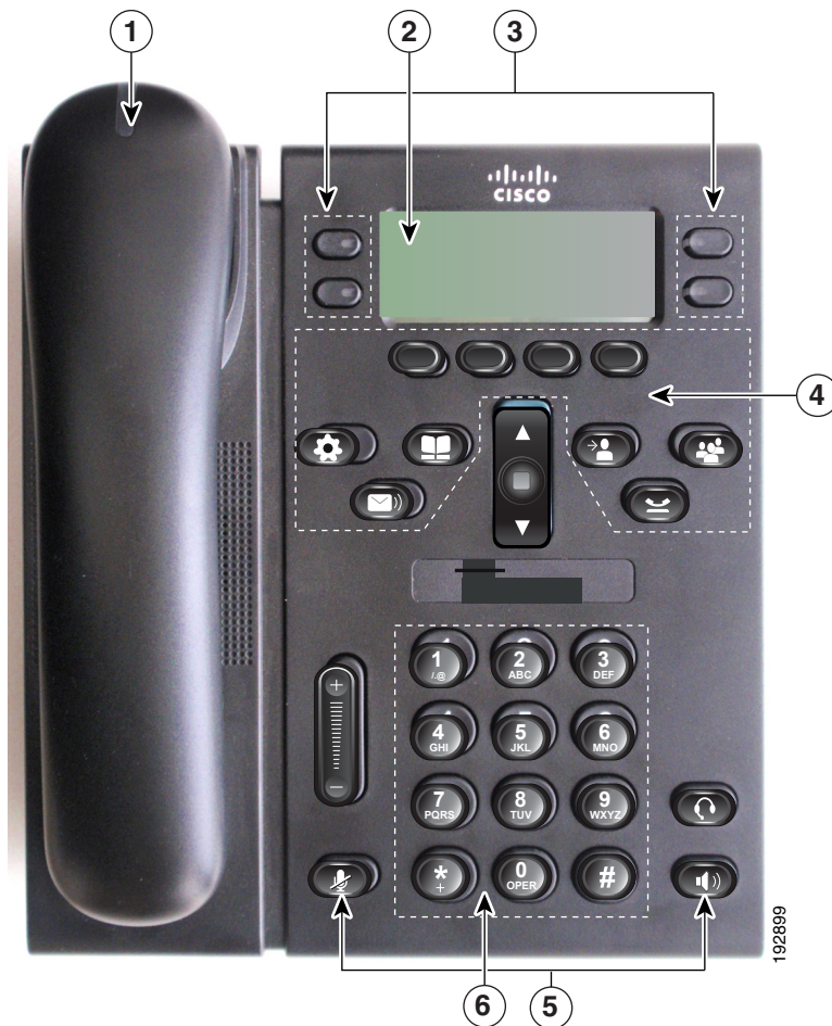
図 2 視覚障がい者向けアクセシビリティ機能 : Cisco Unified IP Phone 6941
