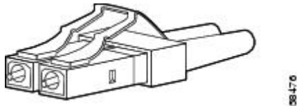
図 39: 光ファイバ SFP モジュールの LC コネクタ
