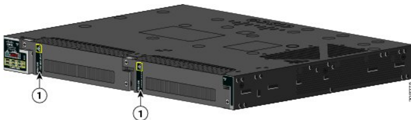
図 27: 電源モジュールの挿入
