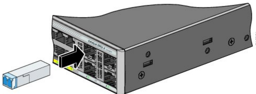
図 35: SFP モジュールの取り付け
