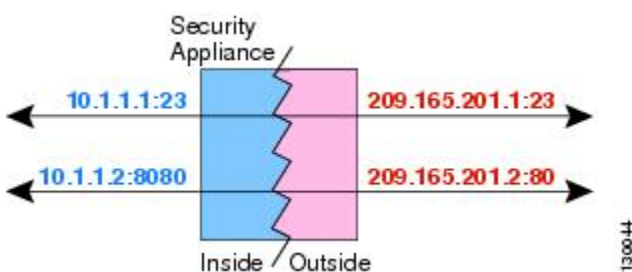
図 27: ポート変換を設定したスタティック NAT の一般的なシナリオ
