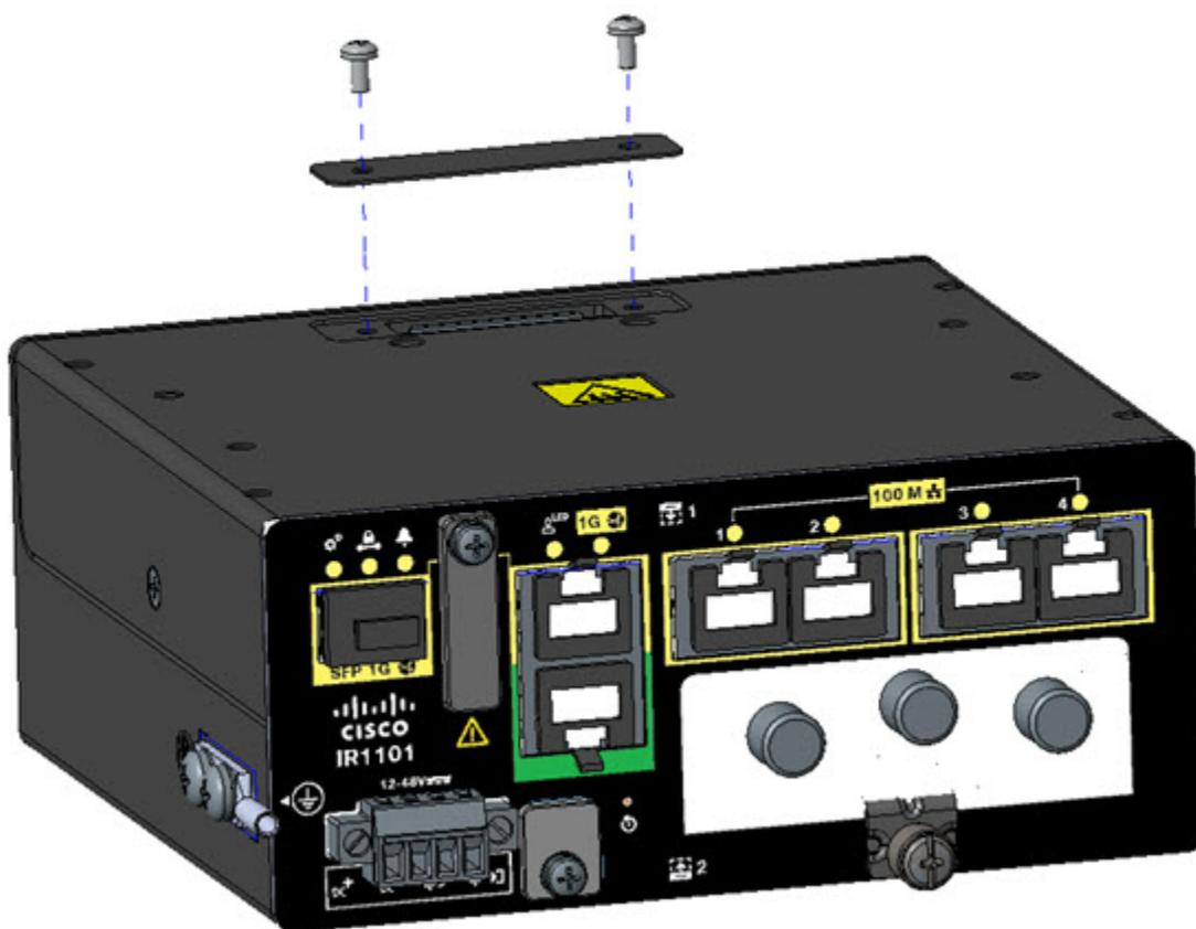
**ステップ2** IR1101から保護コネクタカバーを取り外した後、拡張モジュールとIR1101の位置を慎重に合わせて、両方のコネクタが接続されるようにします。次の図を参照してください。適切に密着させた後、4本のネジを取り付けて、拡張モジュールをIR1101に完全に固定します。
