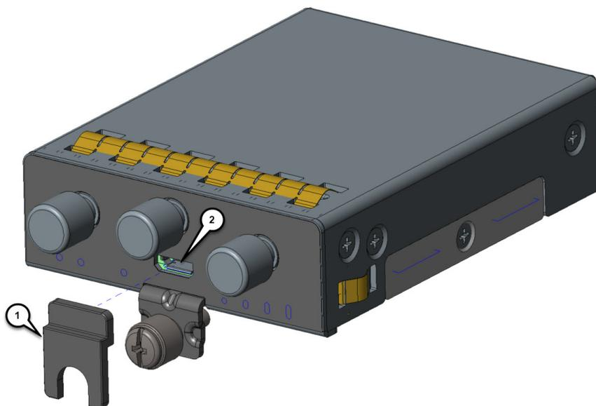
**ステップ7** ラッチロックのネジを 2.8 ~ 3.8 インチポンド (0.3 ~ 0.4 ニュートンメートル) のトルクで締めます。USB カバーの取り付けが完了した状態については、次を参照してください。
