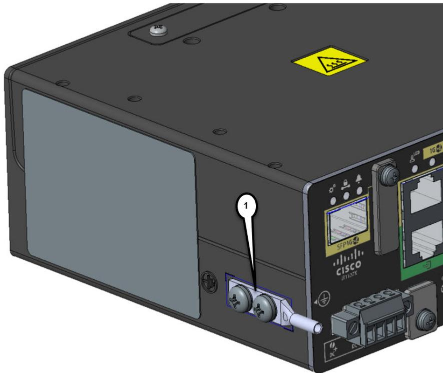
**ステップ 5** アース線の反対側の端を、確実にアースできる接地点に接続します。
