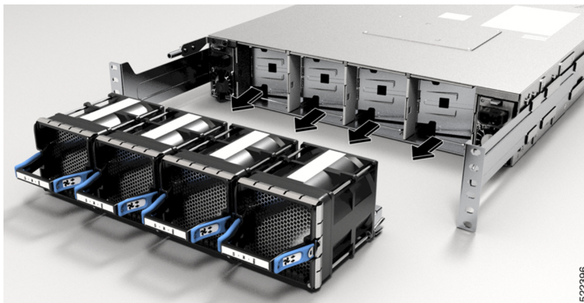
図 48: Cisco 8202-32FH-M ファンモジュールの取り外し
