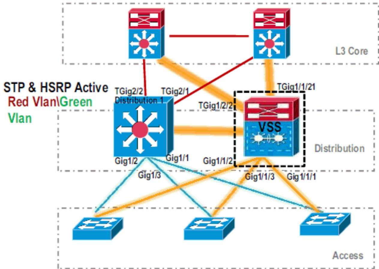
11. 完成以下步驟以預配置VSS Switch 1: 使用Switch-1的本地介面配置MEC。將Switch-2 ( 當前為Distribution-1 ) 的介面轉換為VSS模式後，可以將其新增到MEC。配置MEC。將介面配置移動到MEC。將QoS和ACL策略移動到MEC。**初始配置**
