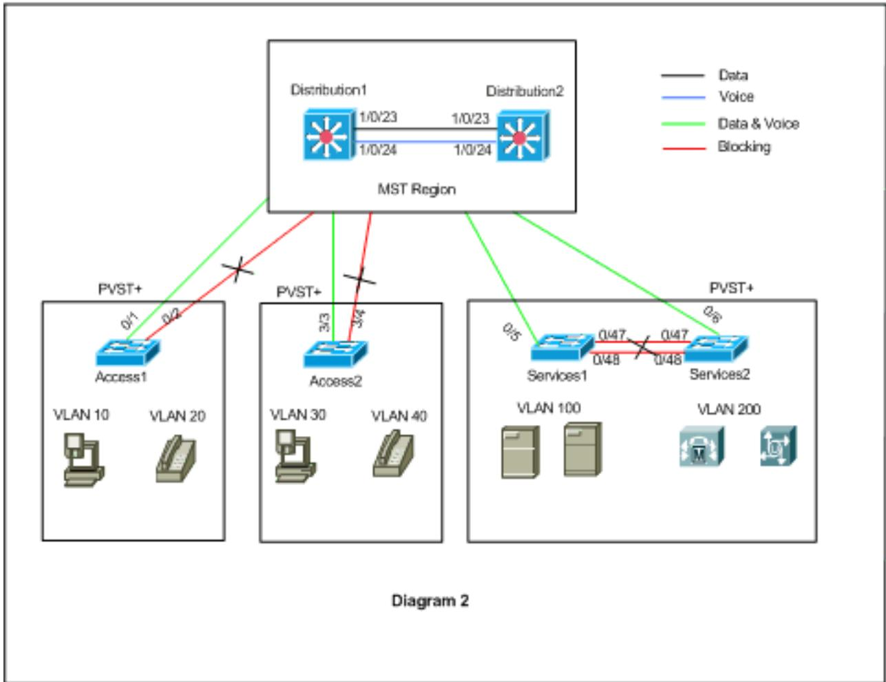
Distribution1和Distribution2位於MST區域1中，PVST+交換機將區域1視為單個網橋。重新收斂後的流量如圖2所示。您仍然可以按照圖1調整PVST+（生成樹VLAN X開銷）交換機，以負載均衡資料和語音流量。按照步驟2至4遷移所有其他交換機後，按照圖1獲得最終生成樹拓撲。
