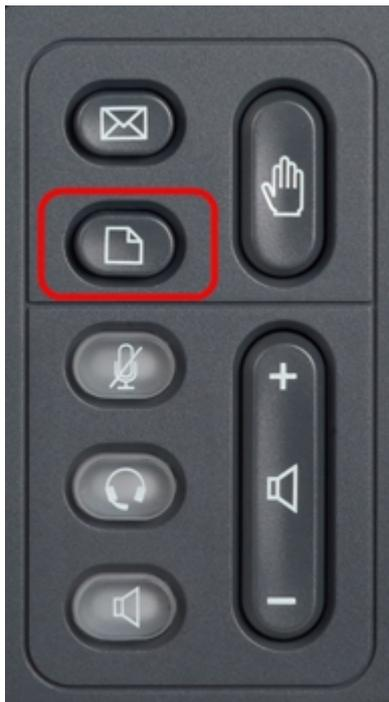
步驟1. 按IP電話上的**Setup**按鈕以顯示*Setup*選單。
