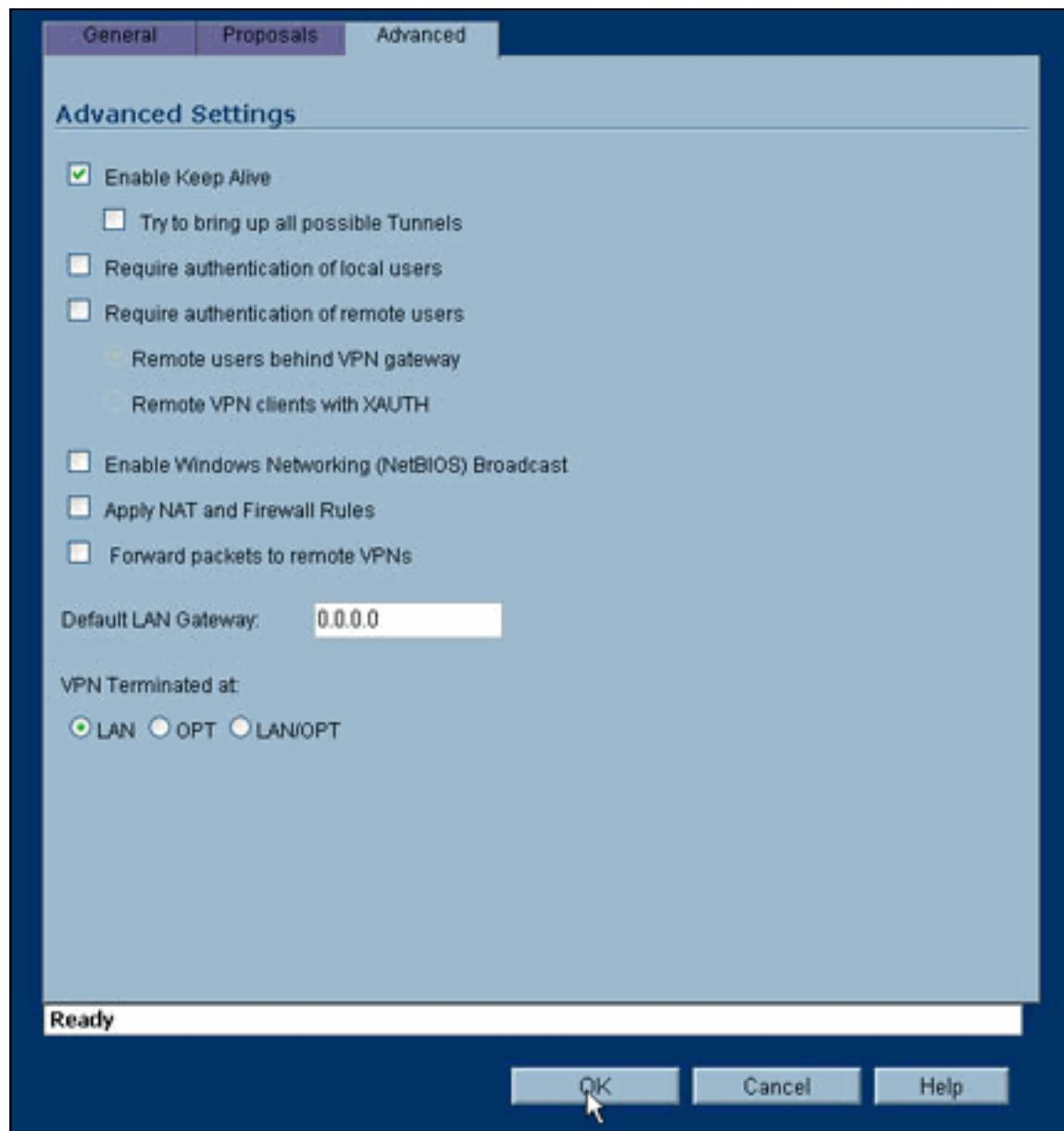
8. 按一下「OK」（確定）。完成此配置和遠端PIX上的配置後，「設定」視窗應類似於此示例「設定」視窗。
