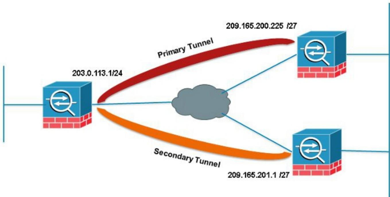
在此範例中，IP站台層級彙總(SLA)用於監控主通道。如果對等體發生故障，備份對等體將接管主節點，但SLA仍會監控主節點；主節點恢復後，生成的系統日誌將觸發EEM清除輔助隧道，允許ASA再次與主節點重新協商。
