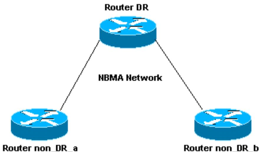
當Router non\_DR\_a計算通過Router non\_DR\_b的路由時，它會使Router non\_DR\_b成為下一跳。但是，Router non\_DR\_a沒有到Router non\_DR\_b的虛擬電路(VC)，這表示這些路由器無法彼此ping。OSPF使用無法到達的下一跳將路由安裝到路由表中。
