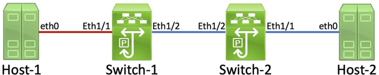
在此拓撲中，名為 Switch-1 之 Nexus 交換器的介面 Ethernet1/1 會透過 Host-1 的網路介面卡(NIC) eth0 連線至名為 Host-1 的主機。Switch-1 的介面 Ethernet1/2 會透過 Switch-2 的介面 Ethernet1/2，連線至第二個名為 Switch-2 的 Nexus 交換器。Switch-2 的 Ethernet1/1 介面透過 Host-2 NIC eth0 連線到名為 Host-2 的主機。
