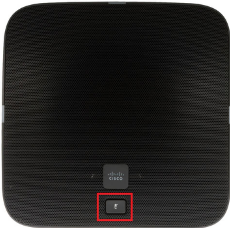
步驟3.繼續按下MIC按鈕並開啟電話電源（插入乙太網電纜或電源模組）。當電話左、右和背面的指示燈從綠色變為紅色時，放開MIC按鈕，如下圖所示。
