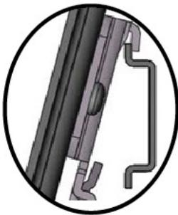
**注释** 确保 DIN 导轨固定在防滑夹中。
