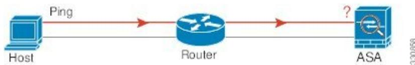
图 3: IP 寻址问题引发的 Ping 故障
