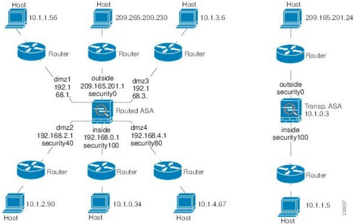
**步骤 2** 从直接连接的路由器 ping 每个 ASA 接口。对于透明模式，ping BVI IP 地址。此测试可确保 ASA 接口处于活动状态，并且接口配置正确。
