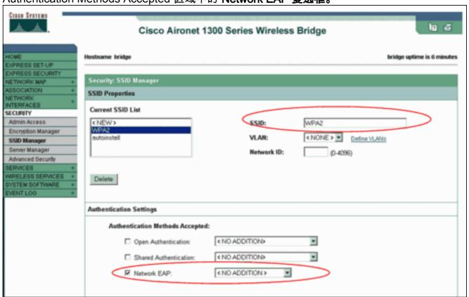
注意:在无线电接口上配置身份验证类型时,请遵循以下准则:Cisco 客户端 - 使用 Network EAP。第三方客户端(包括与 Cisco Compatible Extensions [CCX] 兼容的产品)- 使用采用 EAP 的开放式身份验证。Cisco 客户端与第三方客户端的组合 - 同时选择 Network EAP 和 Open Authentication with EAP。将 Security SSID Manager 窗口向下滚动到 Authenticated Key Management 区域,并完成以下步骤:在 Key Management 菜单中,选择 Mandatory。选中右侧的 WPA 复选框。单击 Apply。注意:VLAN的定义是可选的。如果定义了 VLAN,则与此 SSID 的使用关联的客户端设备将被划分到 VLAN 中。有关如何实施 VLAN 的详细信息,请参阅配置 VLAN。
