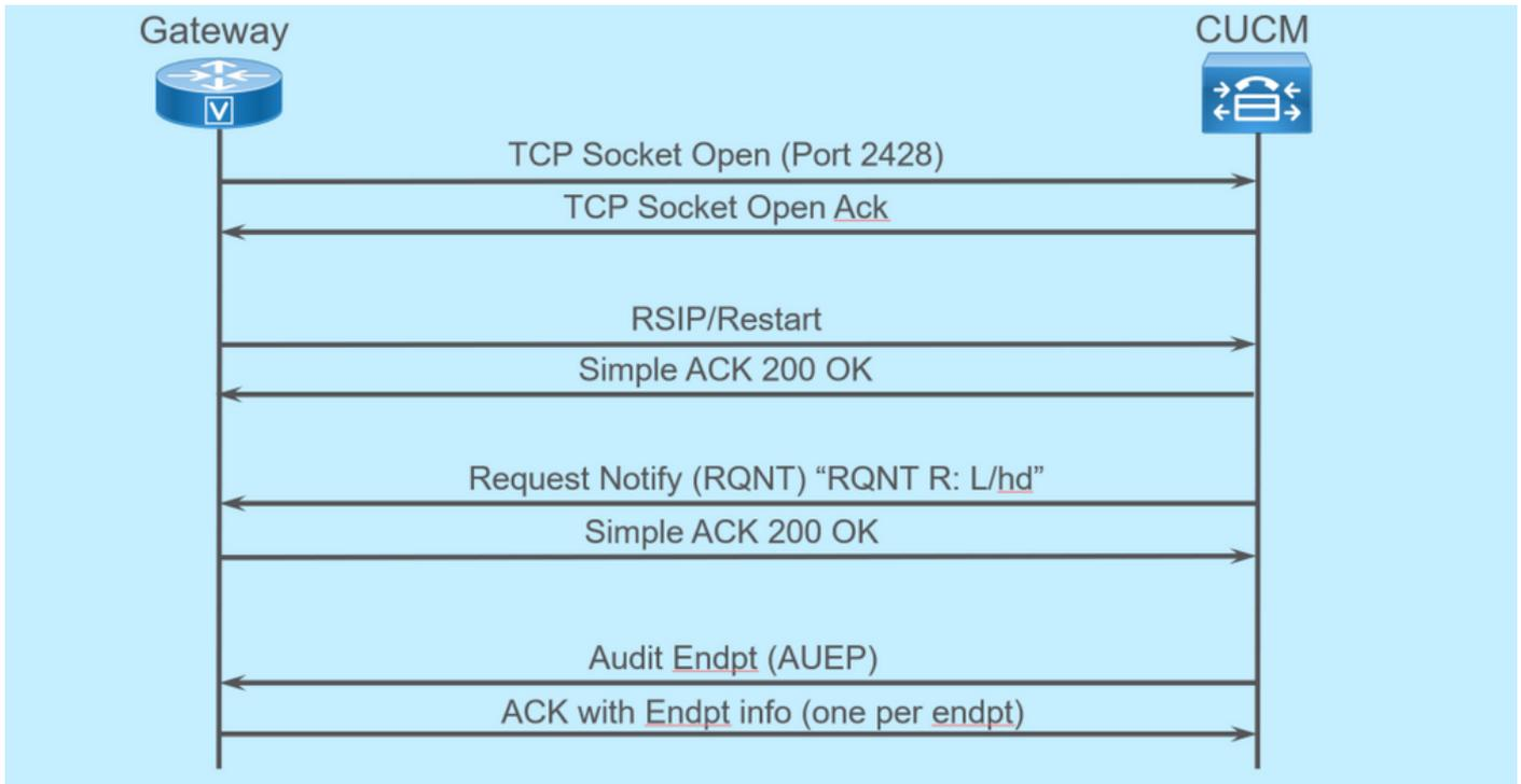
对于要注册到CUCM的MGCP终端，网关将打开TCP套接字2428到CUCM。在此处，它使用UDP端口2427发送命令消息。一旦套接字打开，网关就会向CUCM发送RSIP命令，通知它重启时终端必须停止服务，CUCM会发送有关此情况的简单确认。重新启动完成后，CUCM会发送一个参数为R: L/hd的RQNT。这表示网关必须通知CUCM摘机事件。
