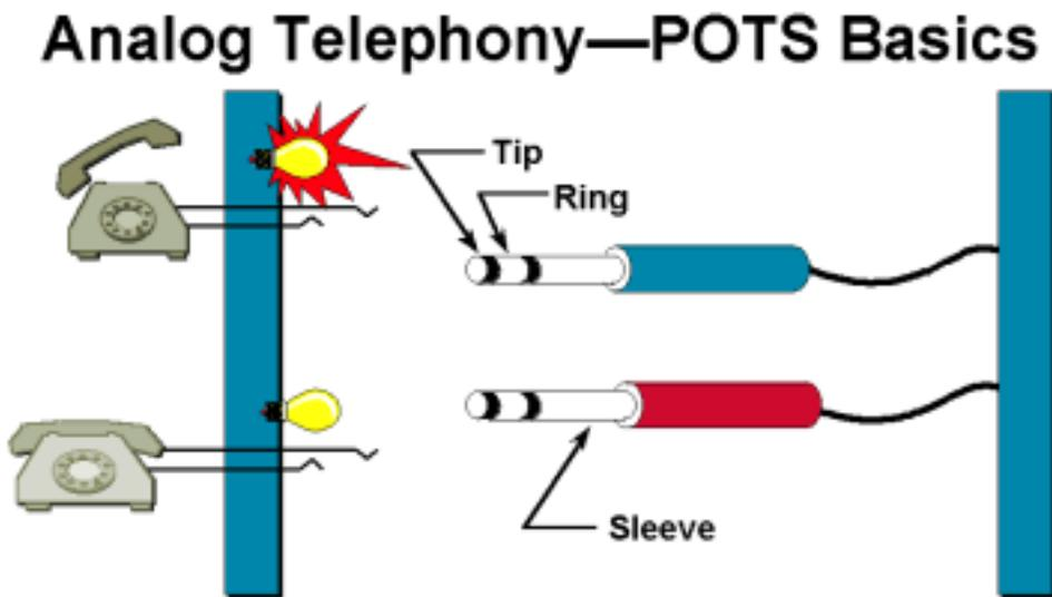
在此图中，头端线和环线均与地断开。PBX 和 FXO 不断监控头端线的接地情况，而 CO 和 FXS 则不断监控环线的接地情况。电池(-48 VDC)仍与环路启动信令一样连接到环路线。图 17 显示了来自 PBX 或 FXO 的呼叫。
