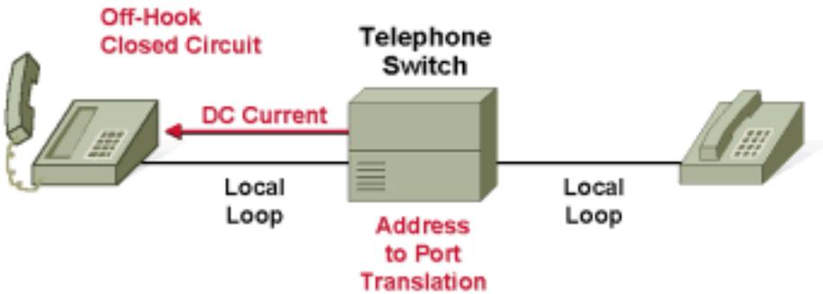
在交换阶段，CO 交换机将脉冲或语音转换为端口地址，该地址将连接到被叫方的电话机。此连接可能直接访问所请求的电话机（本地呼叫），也可能通过另一台交换机或另几台交换机（长途呼叫）到达最终目的地。图 5 显示振铃阶段。
