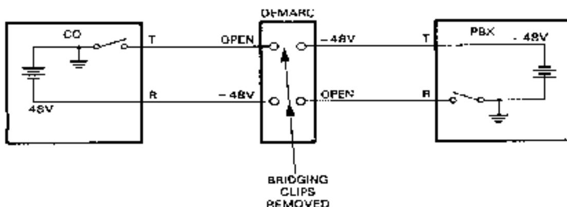
理想情况下，从R连接到分界点CO侧的地，或从T连接到PBX侧的地电压表读取大约-48V。在T和CO侧地线之间连接的欧姆计可读到非常高的阻抗。空闲状态下，许多PBX在R和地线之间存在一定的电压。如果尝试测量电阻，则可能测量不正确，计量仪也可能会损坏。在测量分界点PBX侧R与地线之间的电阻之前，请参阅PBX制造商的技术指南。
