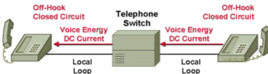
在通话阶段，被叫方听到电话铃响并决定应答。只要被叫方拿起话筒，摘机阶段就再次开始，这一次是在网络的另一端。被叫方一侧的本地环路闭合，因此电流将开始流向 CO 交换机。该交换机检测到此电流并完成返回主叫方电话的语音连接。现在，语音通信将可以在此连接的两端开始。
