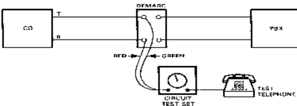
要测量环路电流，请先将测试电话摘机，然后倾听拨号音。测试接地启动中继时，可让 R 引线瞬间接地。听到拨号音后，请按测试装置上的 Push to Measure 按钮并读取环路 mA 刻度上的电流值。理想情况下，读数应在 23 到 100 mA 之间。
