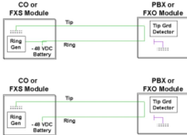
在此图中，PBX 或 FXO 检测到头端线接地和振铃。当 PBX 或 FXO 有要进行连接的可用资源时，PBX 或 FXO 将闭合头端线和环线之间的环路并取消环线接地。CO 或 FXS 从头端线和环线环路检测到电流，然后消除振铃音。PBX 或 FXO 必须在 100 毫秒内检测到头端线接地和振铃，否则电路将超时，呼叫方必须重新呼叫。此 100 毫秒超时有助于防止睨视。
