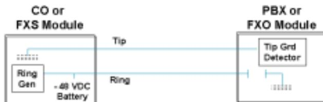
在图 18 中，CO 或 FXS 将头端线接地，然后将 20 Hz 90 VAC 振铃电压叠加到环线上，提醒 PBX 或 FXO 存在传入呼叫。图 19 显示了接地启动信令的最后阶段。
