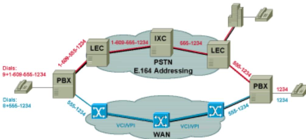
在此图中，呼叫方从用户驻地内部生成呼叫，该驻地使用 PBX 访问公共交换电话网 (PSTN)。要通过 PBX，呼叫方必须先拨 9 (这是大多数 PBX 的设置)。然后，呼叫方必须拨 1 表示长途，再拨呼叫方要拨打的电话的十位数字。使用区域代码会使呼叫方通过两台交换机，即先通过本地交换机，然后通过长途运营商 (IXC) 交换机，通过后一台交换机时将使呼叫成为长途呼叫。使用局代码 (第二组三位数字) 会使呼叫方再次通过本地交换机，然后到达另一个 PBX。最后，使用站点编码 (最后四位数字) 会将呼叫方转到所呼叫的电话。
