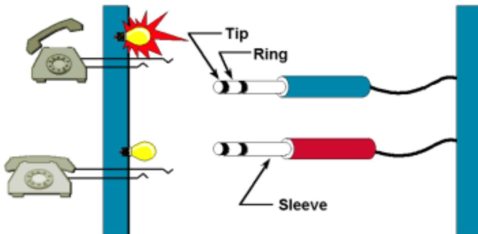
在此图中，电话机、PBX 或 FXO 模块在头端线和环线之间形成了一个闭合环路。电话机将话筒摘机，或者 PBX 或 FXO 模块关闭了电路连接。CO 或 FXS 模块检测到电流，然后生成拨号音，该拨号音将发送到电话机、PBX 或 FXO 模块。这表示用户可以开始拨号。如果从 CO 交换机或 FXS 模
