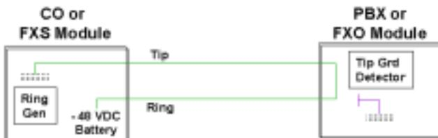
在此图中，PBX 或 FXO 通过将环线接地，向 CO 或 FXS 指示有传入呼叫。CO 或 FXS 检测到环线接地，然后将头端引线接地，告知 PBX 或 FXO 它已准备好接收传入呼叫。PBX 或 FXO 检测到头端线接地，任何闭合头端线和环线之间的环路作为响应。它还会取消环线接地。此过程完成的是到 CO 或 FXS 的语音连接，然后语音通信即可开始。图 18 显示了来自 CO 或 FXS 的呼叫。
