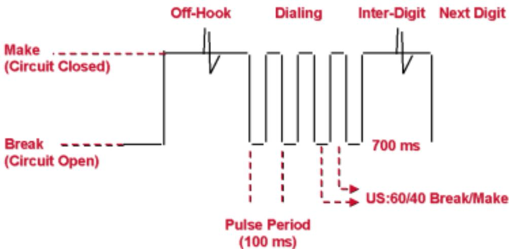
此图显示了两个术语：“接合”和“中断”。当电话摘机时，“接合”发生，呼叫方将收到来自 CO 交换机的拨号音。然后，呼叫方拨打数字，此操作将生成“接合”和“中断”序列，这些序列每 100 毫秒 (ms) 生成一个。“中断”和“接合”周期必须对应于 60% 的“中断”和 40% 的“接合”这一比率。然后，电话会停留在“接合”状态，直到拨打另一个数字或将电话置回挂机（等同于“中断”）状态。由于生成的脉冲数等同于所拨的数字，因此拨号脉冲编址是一个非常缓慢的过程。因此，当拨打数字 9 时，将生成九个“接合”和“中断”脉冲。数字 0 生成十个“接合”和“中断”脉冲。为了增加拨号速度，研究人员开发了一种新的拨号技术 (DTMF)。图 9 显示了由 DTMF 拨号（也称为按键式拨号）生成的音频。
