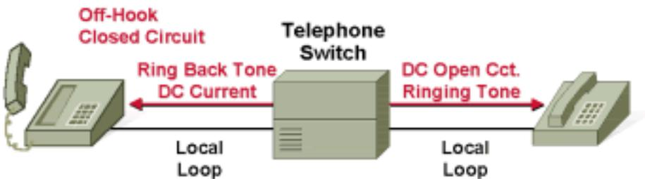
一旦 CO 交换机连接到所呼叫的线路，该交换机将向此线路发送 20 Hz 90V 信号。此信号促使被叫方电话振铃。促使被叫方电话振铃的同时，CO 交换机会向呼叫方发送可听见的回铃音。此回铃音是为了让呼叫方知道，被叫方电话已发生振铃。CO 交换机向主叫电话传输 440 和 480 Hz 的语音
