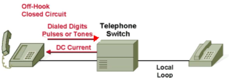
在拨号阶段，用户可以输入其他位置的电话的电话号码（地址）。用户可以使用生成脉冲信号的转盘式电话或生成语音的按键式电话输入该号码。这些电话使用两种不同类型的地址信令，因此电话公司可以据此了解用户拨打电话的位置：双音多频 (DTMF) 拨号和脉冲拨号。
