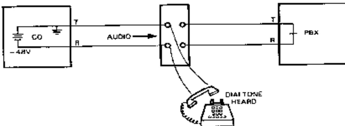
一旦测试电话收到拨号音，您就可以继续使用 CO 允许的 DTMF 或拨号脉冲信令进行拨号。某些 CO 已经经过了配置，可以只接收拨号脉冲编址。经过配置能够接收 DTMF 的 CO 也可接收拨号脉冲。收到第一个拨号数字时，CO 将取消拨号音。
