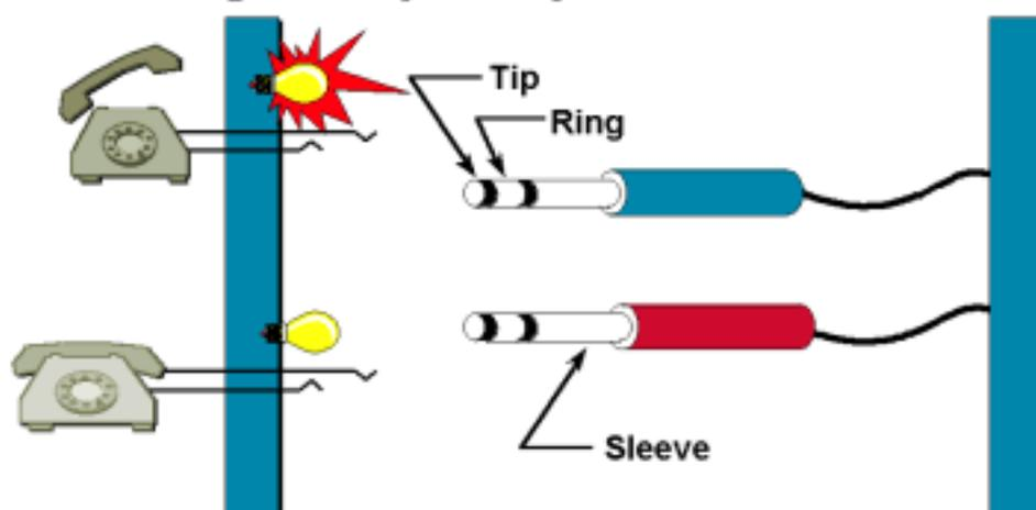
用于在两台电话机之间传输语音的标准方式是使用头端线和环线。头端线和环线是通过 RJ-11 连接器连接到您的电话的双绞线。套管是此 RJ-11 连接器的接地线。
