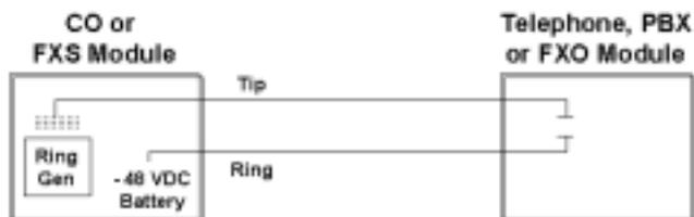
在此空闲状态中，电话机、PBX 或 FXO 模块具有一条打开的双线环路（头端线和环线打开）。它可以是话筒挂机的电话机，也可以是在头端线和环线之间产生开路的 PBX 或 FXO 模块。CO 或 FXS 将等待会产生电流的闭合环路。CO 或 FXS 具有连接到顶线的环形发生器，环形线上的 -48VDC。图 12 显示了电话机的摘机状态，或者 PBX 或 FXO 模块的线路占用情况。
