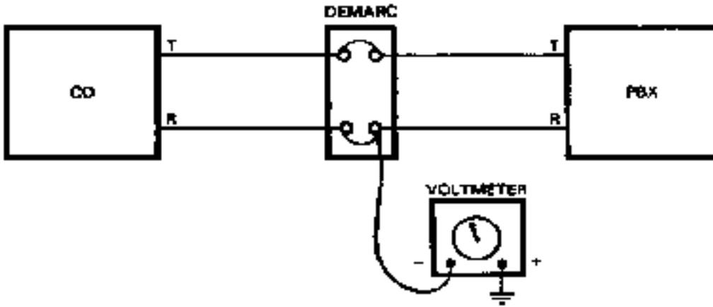
呼叫得到应答时，PBX 将电池放置在 T 引线上并将 R 引线接地。此种情况称为 T-R 反转。在电压表上可以观察到此电压反转。由于在 T-R 引线上将电池和接地反转，因此此种类型的信令称为环路反向电池。
