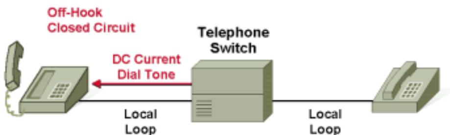
当电话用户决定拨打电话并从电话支架上拿起话筒时，将进入摘机阶段。电话机叉簧开关将闭合 CO 交换机和电话机之间的环路并允许电流流动。CO 交换机检测到此电流并将拨号音（不断播放 350 和 440 赫兹 [Hz] 的语音）传输给电话机。此拨号音提示用户可以开始拨号。用户不一定会立即听到拨号音。如果所有电路都已使用，则用户可能需要等待片刻才能听到拨号音。所用 CO 交换机的接入容量决定了拨号音发送到主叫电话需要多长时间。只有在 CO 交换机保留用于存储传入地址的寄存器后，CO 交换机才会生成拨号音。因此，用户在听到拨号音之前不能拨号。如果没有拨号音，则说明寄存器不可用。图 3 显示拨号阶段。
