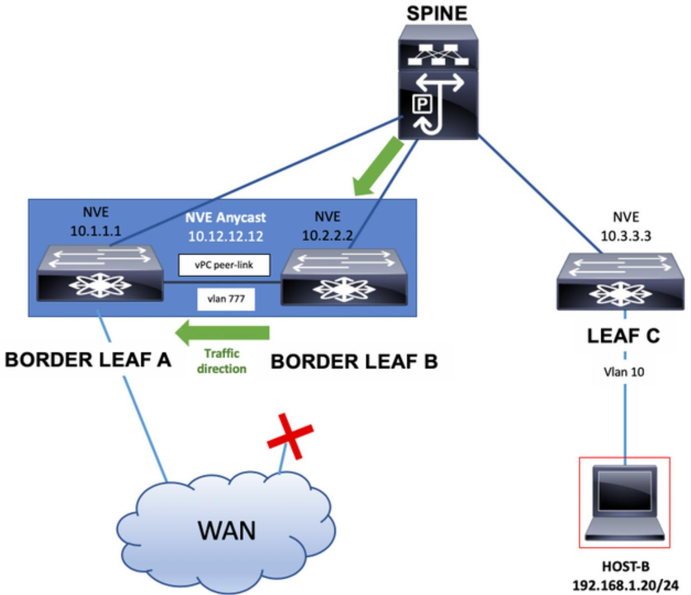
边界枝叶交换机还可以使用静态路由或在租户 — VRF中实例化的路由协议在vPC对等链路上通告接口环回。此流量也将通过vPC对等链路传输。
