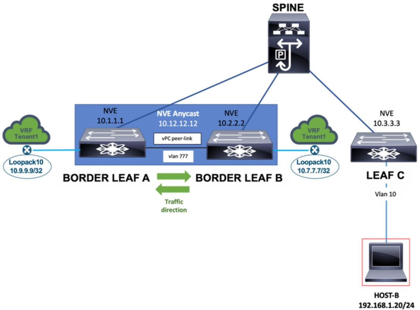
最后，连接到边界枝叶交换机的外部路由器单个主机可以通告网络前缀，这些前缀可能需要vPC对等链路位于网络流量路径中，如下图所示。
