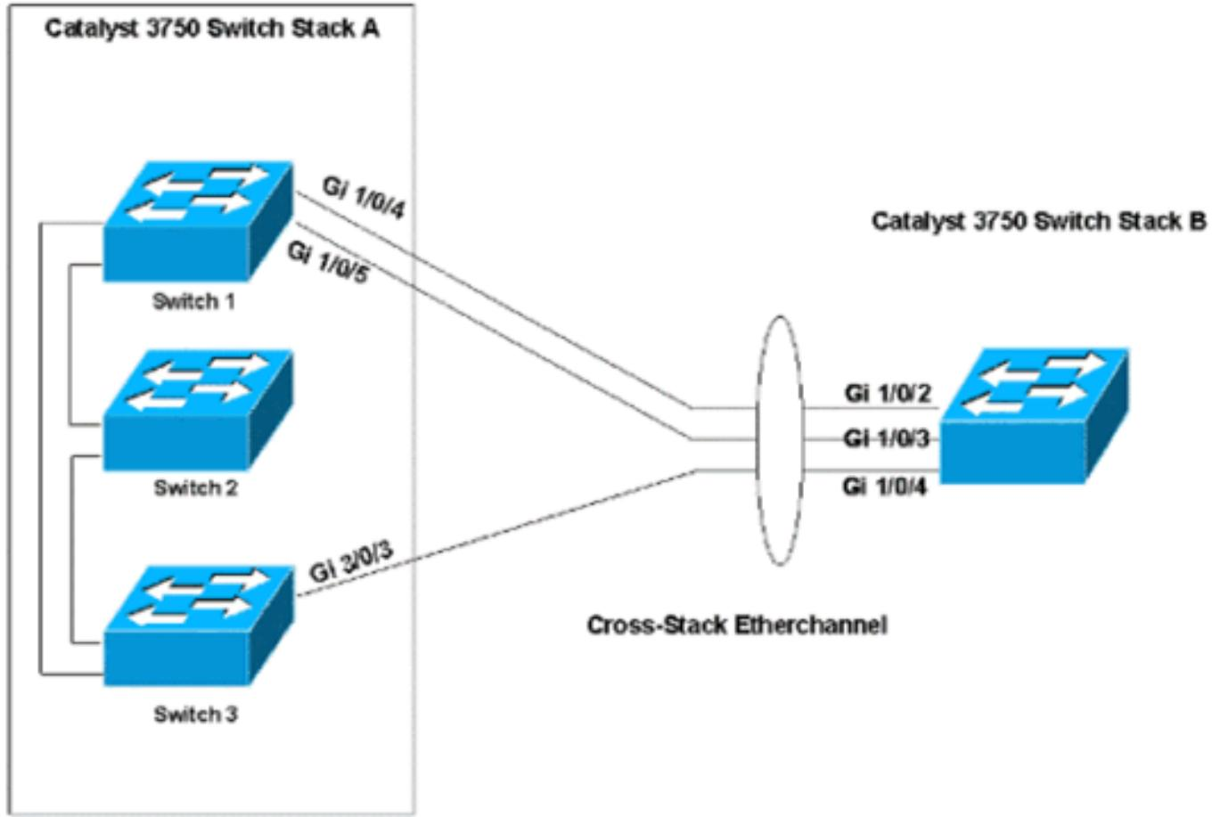
在此网络图中，有两个 Catalyst 3750 交换机堆叠，堆叠 A 和堆叠 B。堆叠 A 有三个交换机成员，而堆叠 B 只有一个交换机成员。EtherChannel由交换机1上的两个端口和堆叠A的交换机3上的一个端口组成。这些端口连接到堆叠B中的三个端口。
