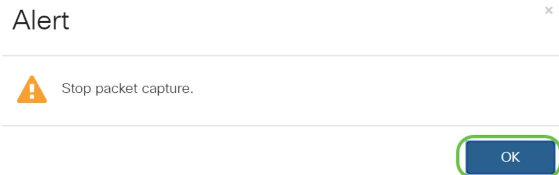
您也可以单击Wireshark应用程序中的“停止”按钮来停止数据包捕获。
