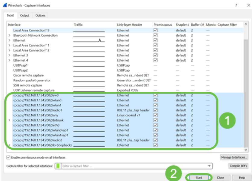
如果在尝试查看数据包时遇到问题，这意味着远程数据包捕获协议服务在您的系统上不工作。远程数据包捕获协议服务必须先要在目标平台上运行，Wireshark才能连接到它。有关详细信息，请单击通过Wireshark的[远程捕获](#)接口链接。
