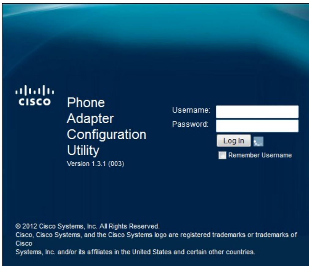
电话适配器的默认IP地址是192.168.15.1。如果未显示网页，请尝试重置IP地址。要重置IP地址，请按住重置按钮30秒。这会将默认IP地址以及所有其他设置重置为出厂默认设置。或者，如果主机计算机的IP地址已知，可以手动将其配置为与电话适配器位于同一子网。
