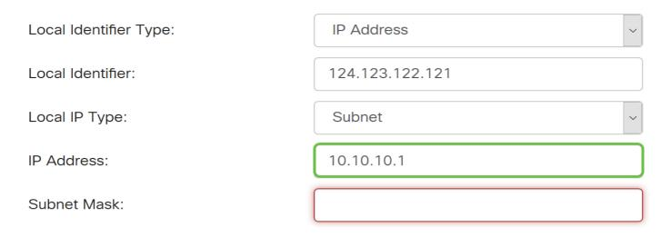
步骤 17在Subnet Mask字段中输入IP地址的子网掩码。
