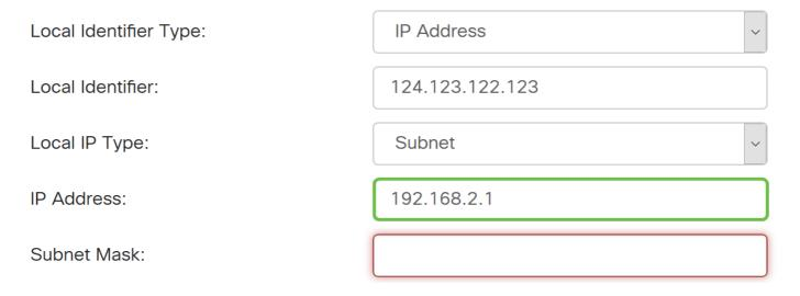
步骤 20.在Subnet Mask字段中输入IP地址的子网掩码。
