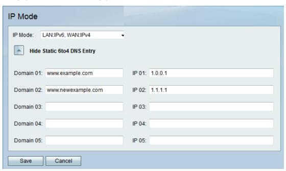
步骤2.在域(01-05)字段中输入域名。此域指定要映射的IPv6地址的主机名。 步骤3.在IP(01-05)字段中输入要映射到的域的IP地址。
