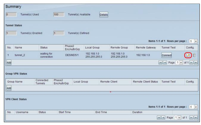
第三步:点击Config(配置)图标下的Edit Configuration图标,以编辑站点2的VPN配置。 Gateway To Gateway页面打开:
