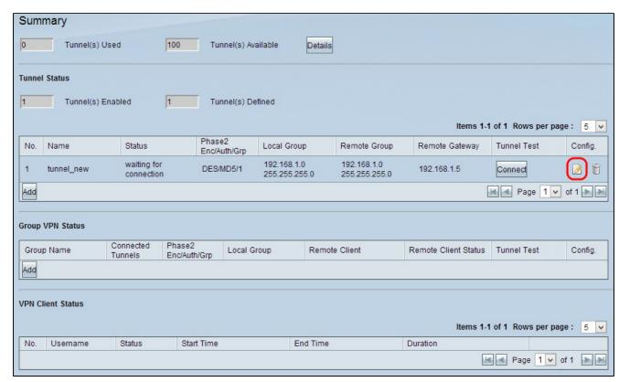
第三步:点击Config(配置)下的Edit configuration(编辑配置)图标,以编辑站点1的 VPN配置。Gateway To Gateway页面打开:
