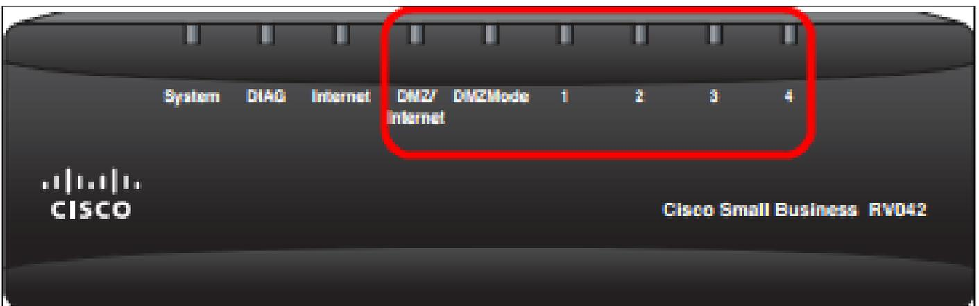
注意：除系统指示灯之外的所有指示灯都不会发光，这表示重新启动正在进行中。指示灯重新亮起后，路由器即可使用。
