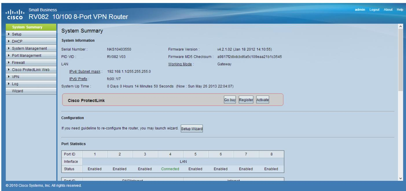
系统摘要页面显示要配置的设备的的基本信息。屏幕左侧的导航树将所有不同的配置选项归入类别。
