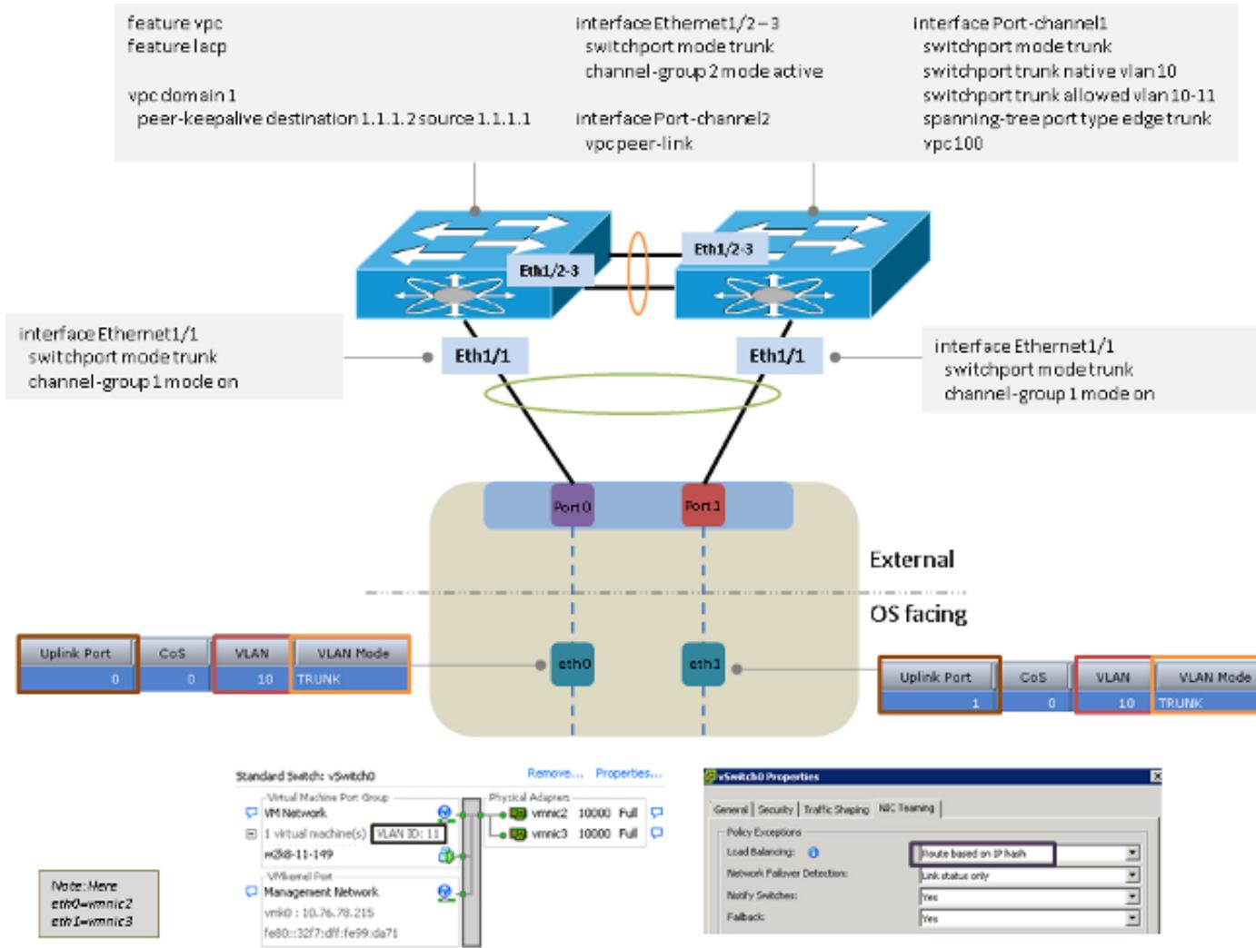
使用多台VMware标准交换机连接到同一交换机的两条上行链路
