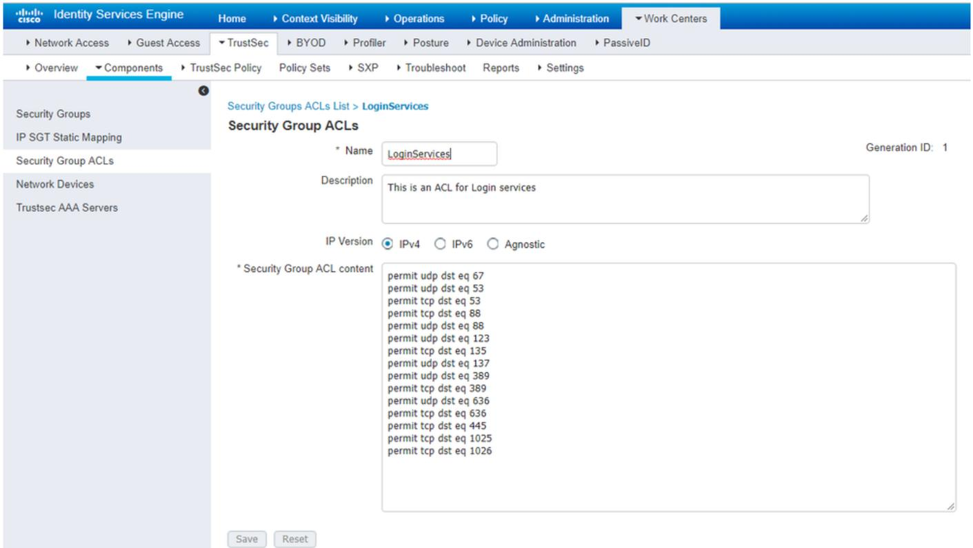
将所有最终用户重定向至Cisco ISE（用于BYOD门户重定向）。不包括DNS、DHCP、ping或WebAuth流量，因为这些流量无法转到Cisco ISE：
