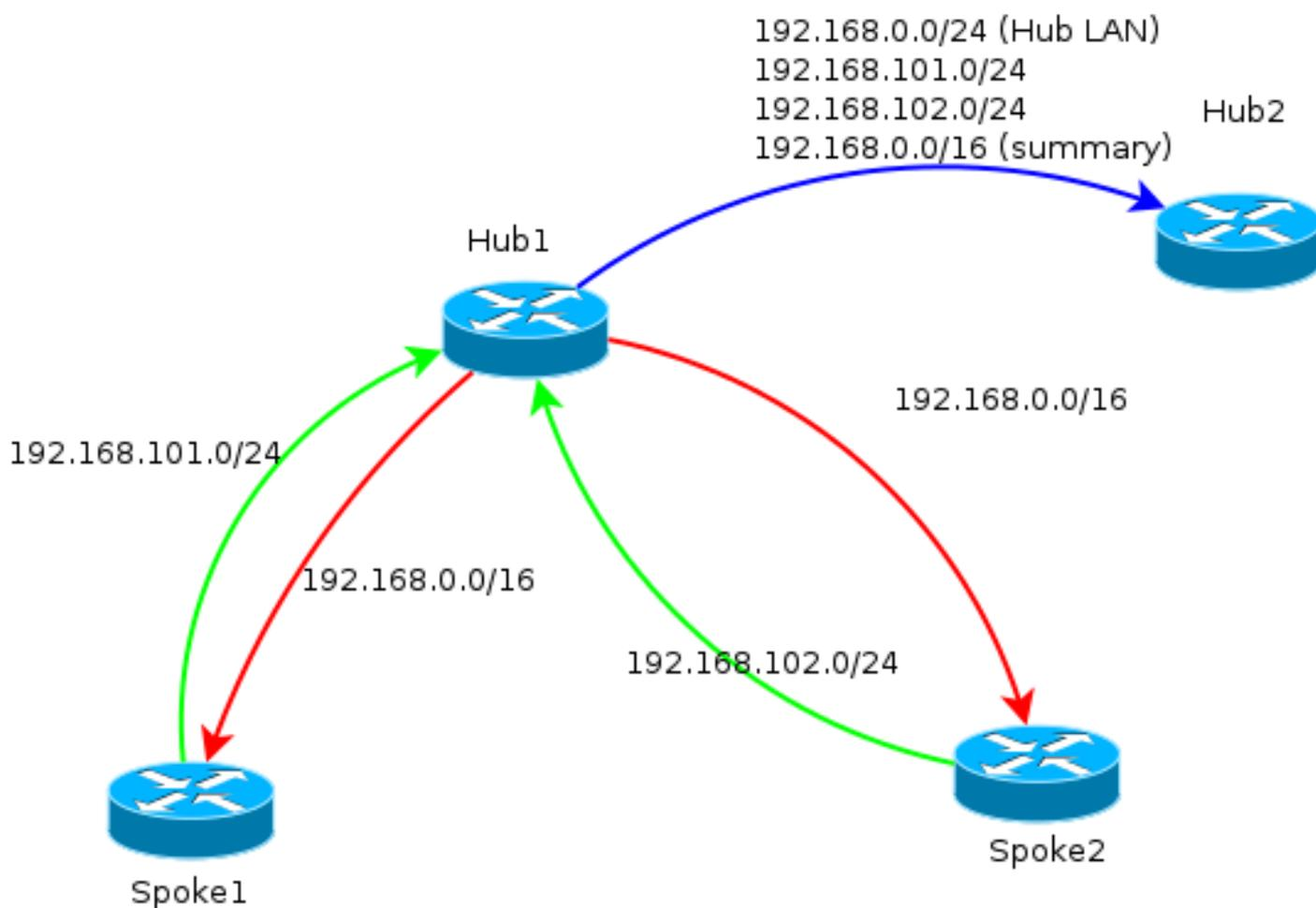
注意：在此图中，绿线表示辐条向集线器提供的信息，红线表示每个集线器向辐条提供的信息（仅摘要），蓝线表示集线器之间交换的前缀。
