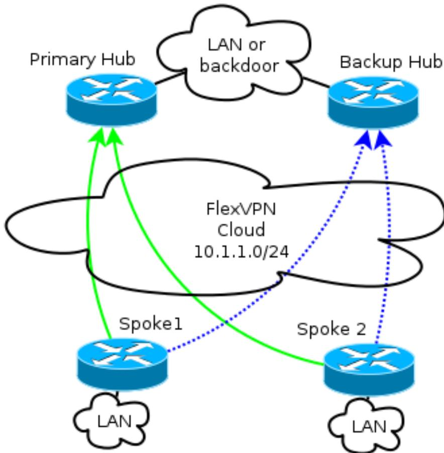
注意：在图中，绿色的实线显示主互联网密钥交换版本2(IKEv2)/Flex会话的连接和方向，蓝色的虚线表示在主集线器的互联网密钥交换(IKE)会话失败时备份连接。
