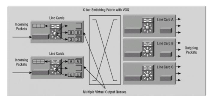
在上图中,虚拟输出队列(A)代表线卡A,VOQ B代表线卡B,依此类推。每个数据包都排序并放入 正确的VOQ中。VOQ中的排序和放置基于思科快速转发(CEF)表中包含的转发信息。
