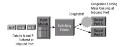
Cisco 12000系列互联网路由器使用独特的多队列实施来消除线路头阻塞。当数据包到达线卡时,它们被安排到按插槽、端口和服务类别(CoS)分类的多个输出队列中的一个。 这些队列称为虚拟输出队列(VOQ)。
