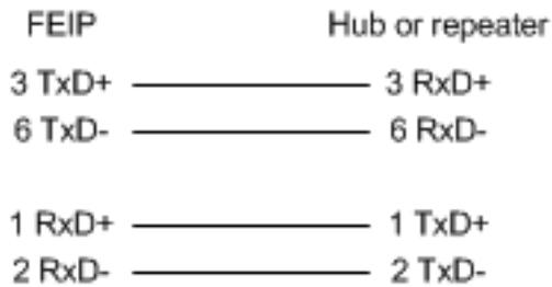
下表列出直通 10BaseT 电缆的端口引脚布局。
