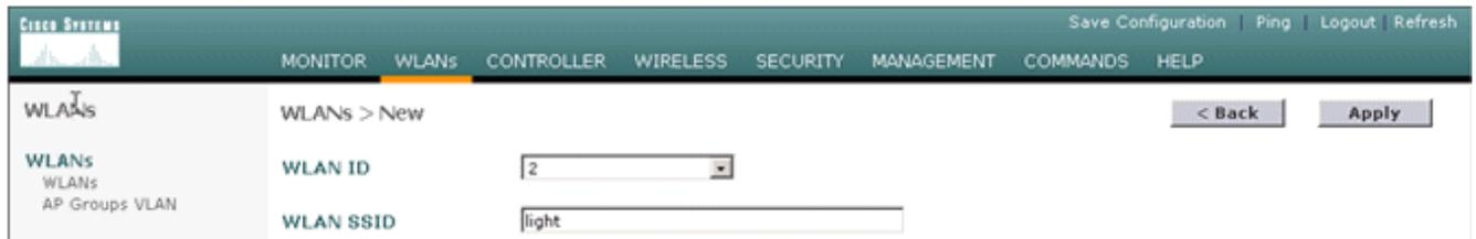
更改接口名称参数到适当的VLAN。其他安全参数，例如适当的RADIUS服务器和加密设置应该对应于在Cisco自治接入点的配置。在本例中，接口名称更改到VLAN45，并且第2层安全类型更改到WPA2。
