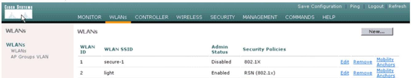
如果使用一新的SSID，没有需要其他配置。如果使用一现有的SSID，每次只请升级一个RF域为了防止在Catalyst 6500 WSLM和Catalyst 6500 WiSM之间的移动性问题。一旦配置WLANs，请检查WLAN策略是否是正确的。例如，ACL，QoS，等等。确定Cisco WCS是正在运行的并且准备被配置管理Cisco WiSM。
