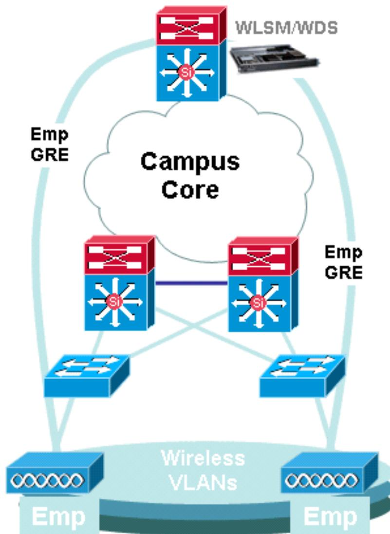
注意VLAN与每SSID仍然产生关联。这些VLAN在接入点在接入层或分布层交换机当前仅被定义，并且不需要被配置。配置的VLAN部分的唯一的目的是提供在与VLAN产生关联的加密之间的捆绑给一特定SSID。
