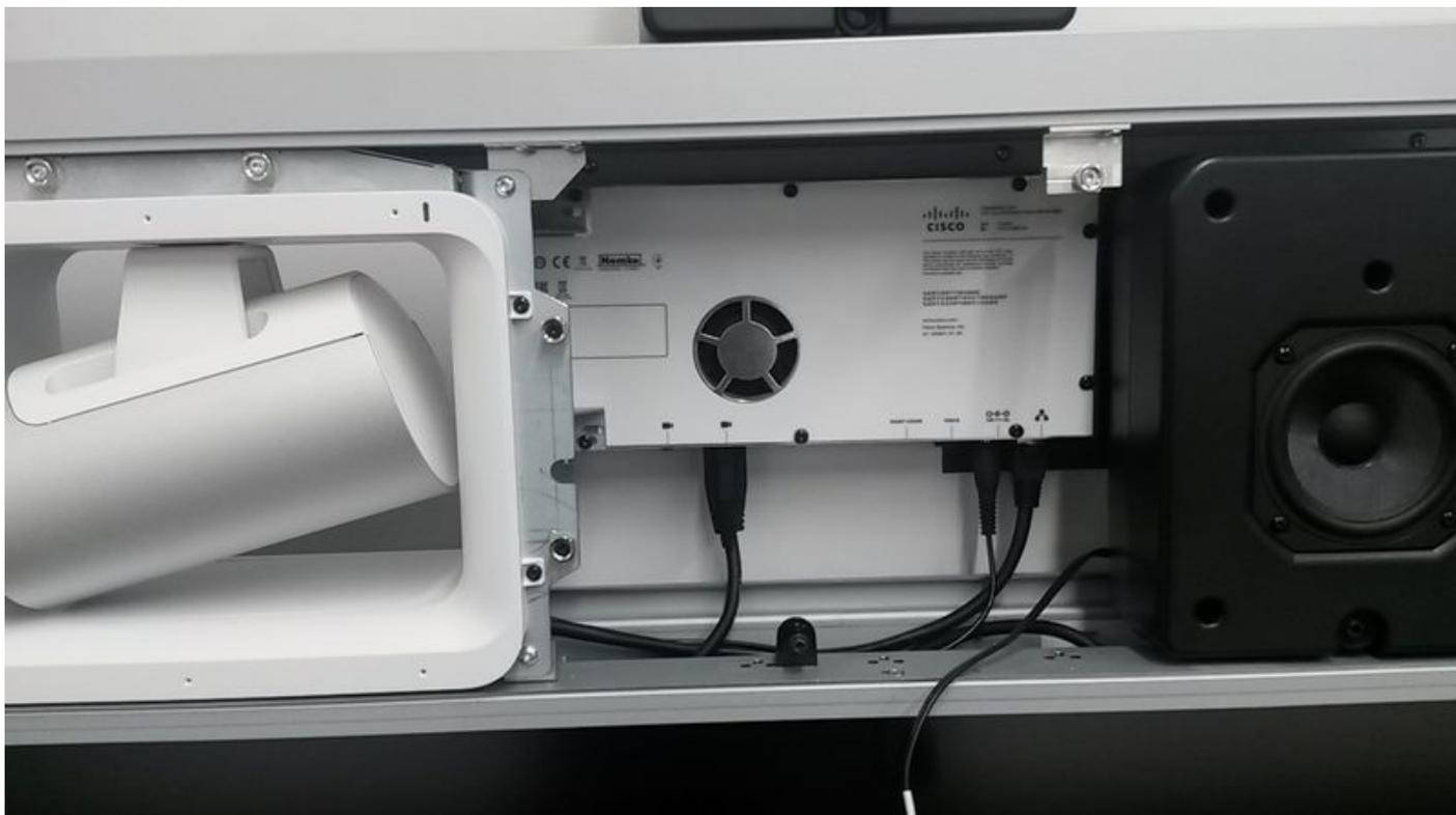
步骤4.在控制面板底部，在螺丝旁边，您能看到针孔。请按与一支笔的针孔大约15秒如镜像所显示，直到照相机的Light emitting diode (LED)闪烁红灯。
