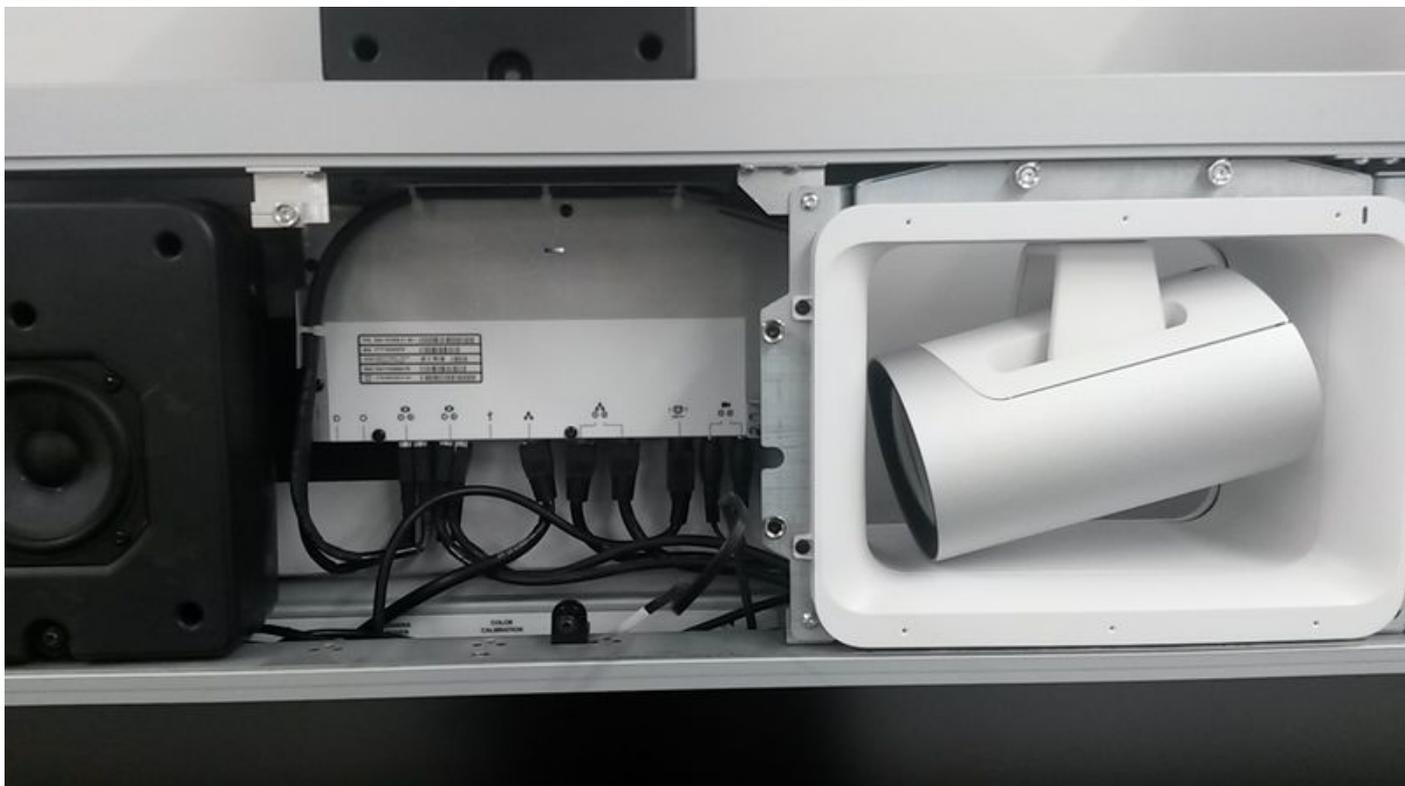
第6步。如镜像所显示，您能在螺丝旁边找到在左下角的针孔，按针孔大约15秒和扬声器跟踪仪重置。
