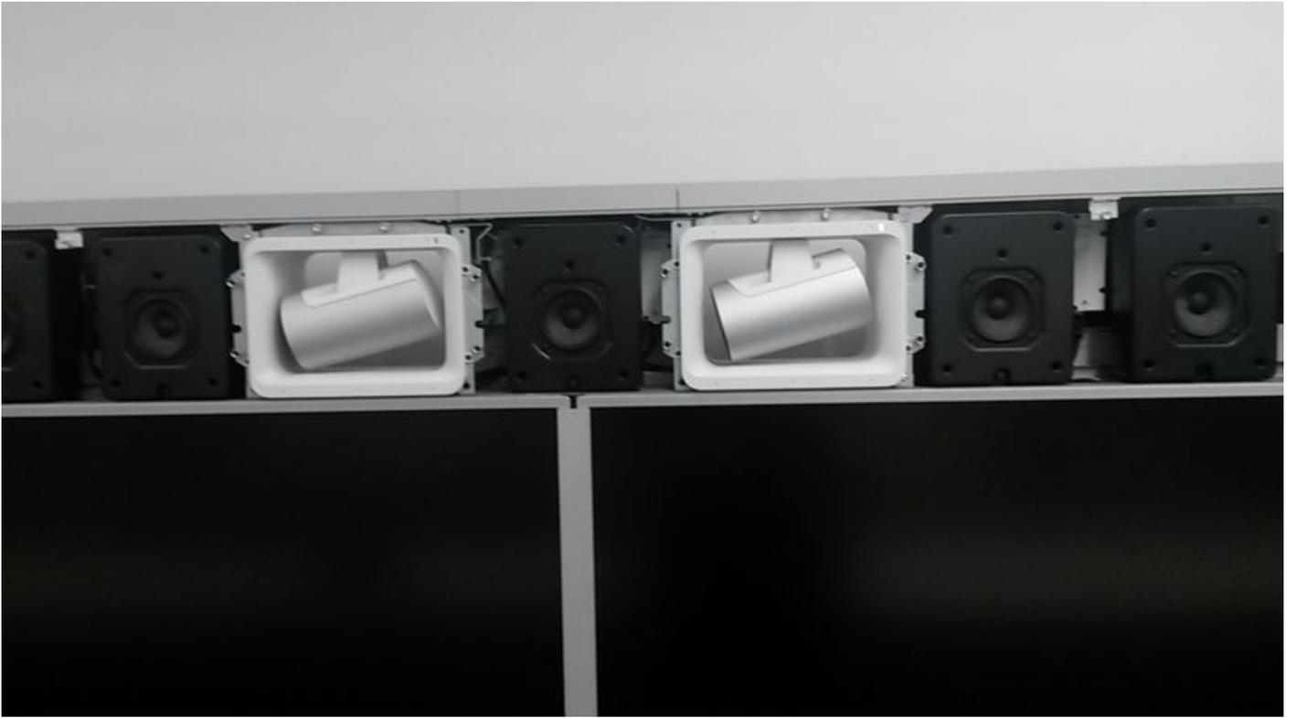
步骤2.如镜像所显示，在照相机旁边去除左，正确和中心的喇叭。
