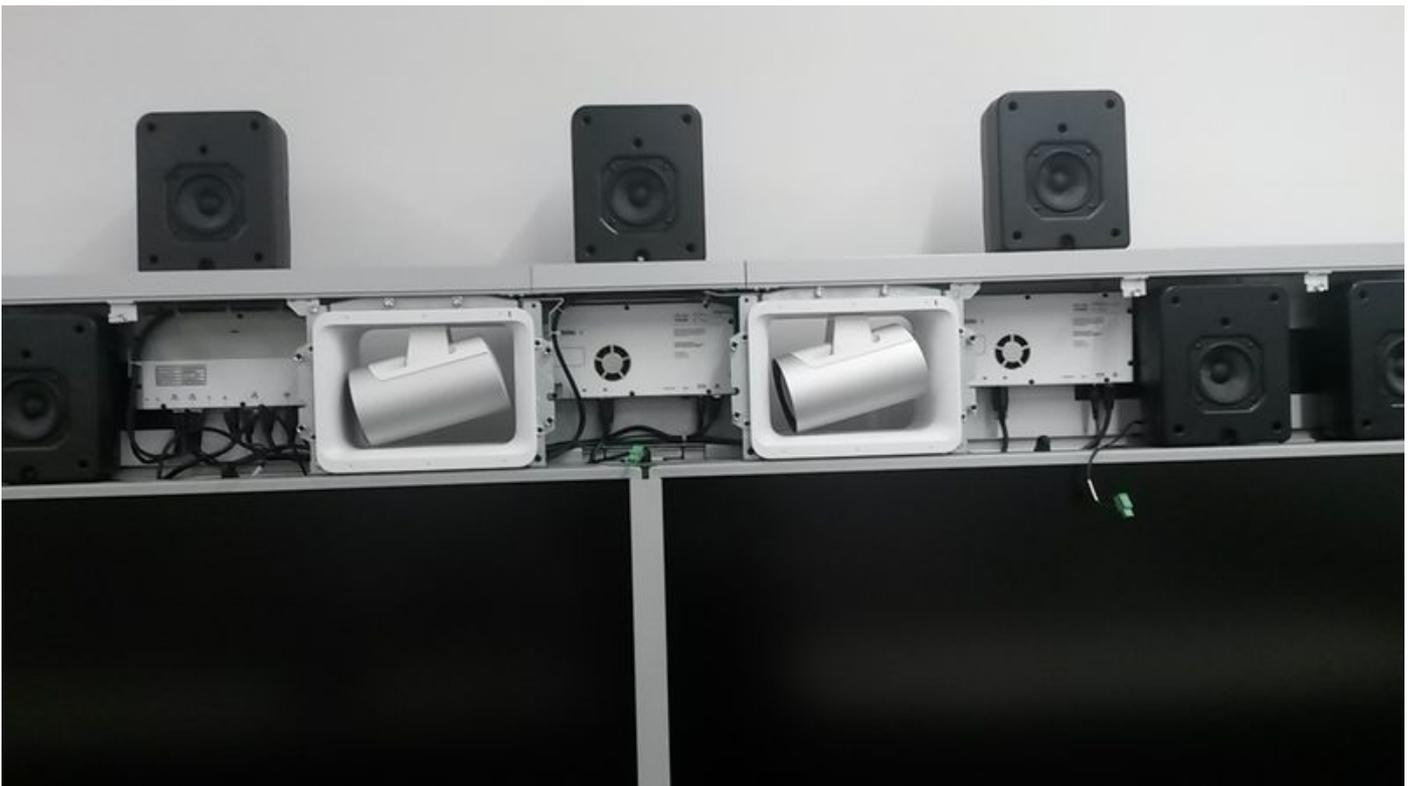
步骤3.如镜像所显示，为了唯一重置照相机，请去每台照相机右侧，您能看到在每个设备的一台风扇。
