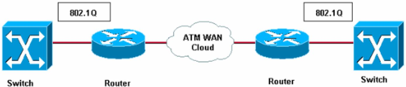
但是，有另一种方法可以构建端到端VLAN。使用相同的网桥组集和802.1Q子接口配置两台路由器。换句话说，两台路由器的两端在网桥组和802.1Q子接口之间有一对一的映射。这不适用于Cisco 7600。
