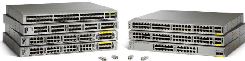
图 9. 从右下方到左上方 Cisco Nexus 2000 系列交换矩阵扩展器的型号依次为：Cisco Nexus 2224TP GE、2248TP GE、2248TP-E GE、2232TM 10GE、2232TM-E 10GE、2232PP 10GE 和 2248 PQ 10GE
