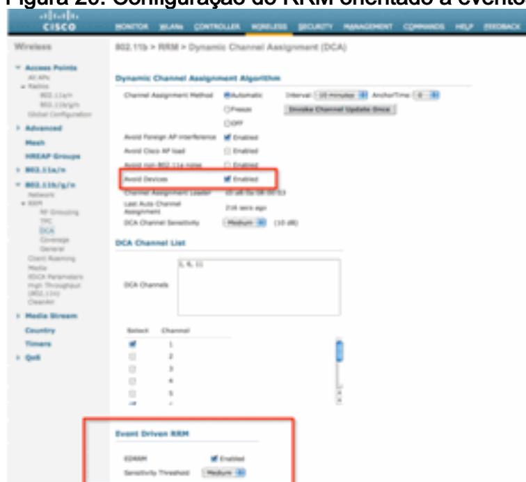
**Observação:** uma vez que o ED-RRM é disparado em um AP/canal, o AP é impedido de retornar a esse canal por três horas. Isso evita o thrashing se a fonte do sinal for intermitente por natureza.
