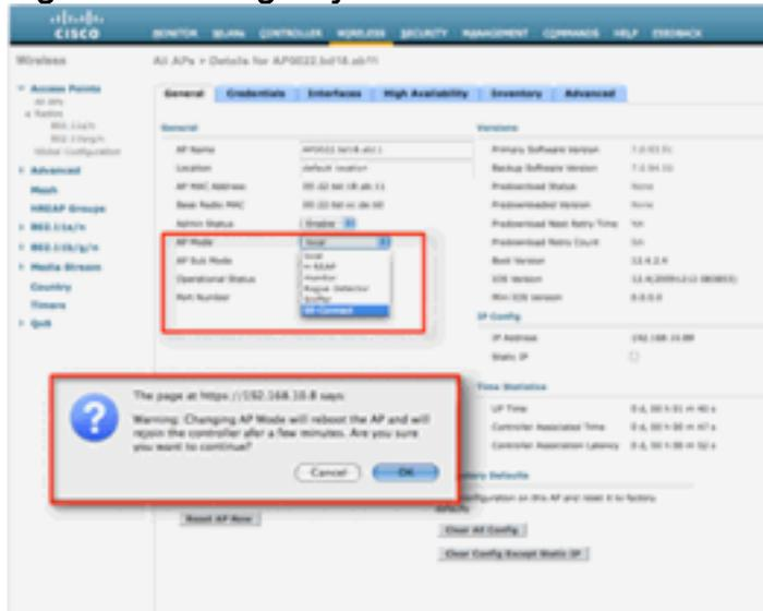
Vá para AP Mode e selecione SE-Connect. Salve a configuração. Você recebe duas telas de aviso: uma avisando que o modo SE-connect não é um modo de atendimento ao cliente, a segunda avisando que o AP é reinicializado. Depois de alterar o modo e salvar a configuração, navegue para a tela **Monitor > Access Points**. Monitore o status do AP e recarregue.
