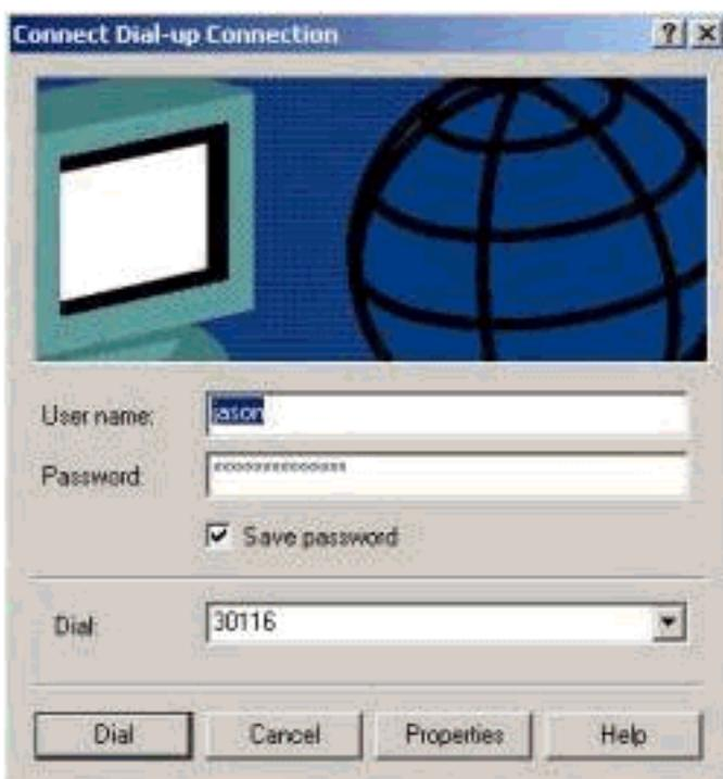
Depois que a conexão dial-up é estabelecida, um endereço IP é alocado do pool de discagem configurado no roteador. Podemos verificar isso emitindo o comando **ipconfig** no host. Ele é exibido como um adaptador PPP no host.
