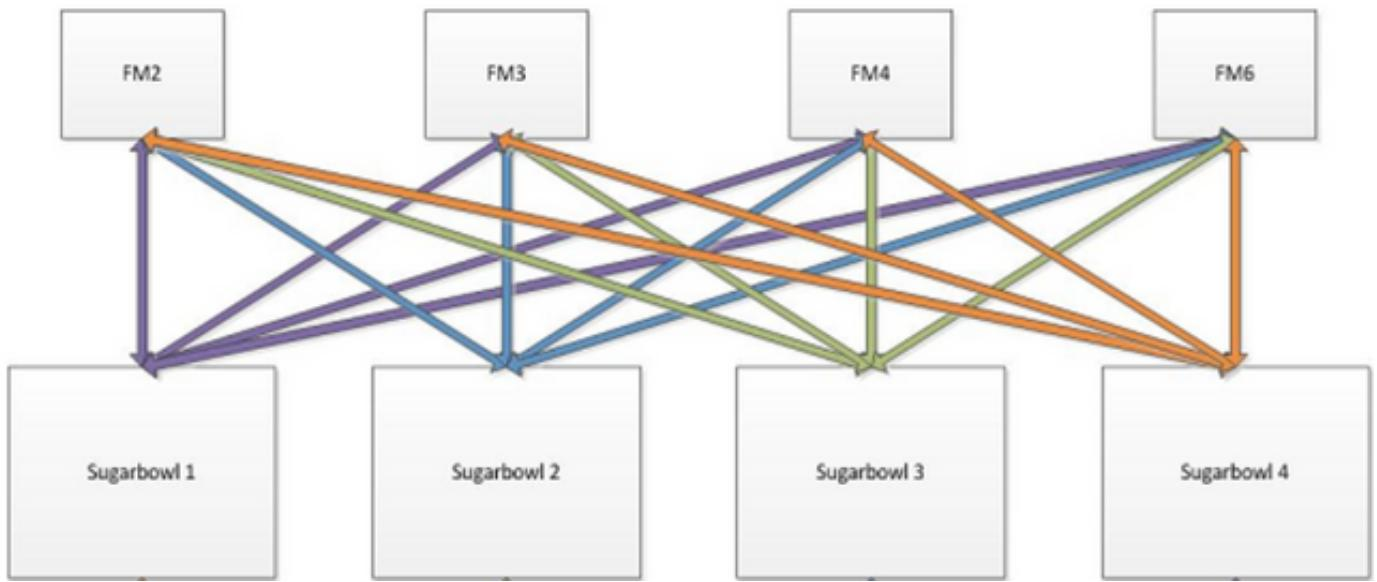
Quando o tráfego recebido por um ASIC precisa sair de outro ASIC ou placa de linha, esse tráfego precisa ser enviado à estrutura através de um módulo de estrutura. O ASIC de entrada selecionará um dos enlaces Ethernet para os módulos de estrutura com base em um hash dos cabeçalhos do pacote e no número de enlaces Ethernet disponíveis para o ASIC.
