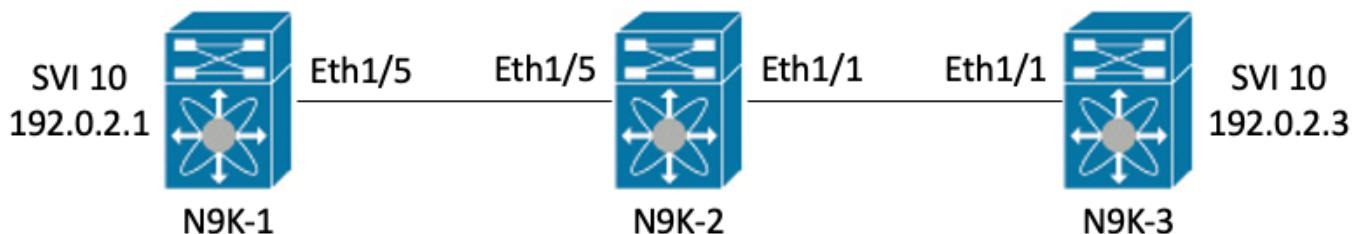
Neste exemplo, erros de CRC propositalmente estopados são gerados no switch N9K-1 através de pacotes ICMP de tamanho gigante de 8000 bytes originados da interface SVI 10 (que possui o endereço IP 192.0.2.1) destinados à interface SVI 10 do N9K-3 (que possui o endereço IP 192.0.2.3), que tem uma MTU de 1500 bytes. N9K-1, N9K-2 e N9K-3 são todos switches modelo Nexus 93180YC-EX.
