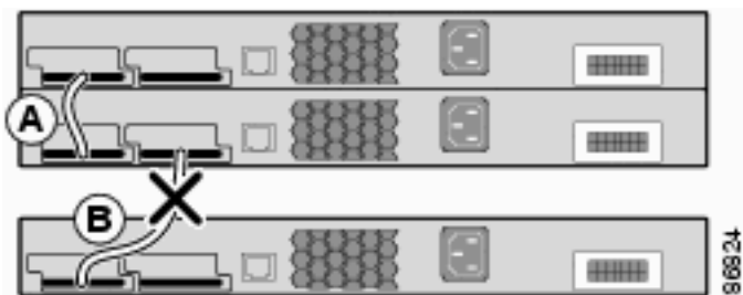
O cabo falha em um único lugar e a pilha é particionada
