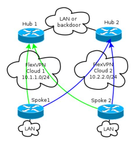
**Note**: No diagrama, as linhas verdes mostram a conexão e a direção das sessões de Internet Key Exchange Version 2 (IKEv2)/Flex para o Hub 1 e as linhas azuis indicam a conexão com o Hub 2.
