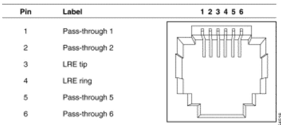
A porta do telefone para o Cisco 575 LRE CPE usa um conector RJ-11. O diagrama a seguir mostra as pinagens do conector da porta do telefone. Observe que os pinos 1, 2, 5 e 6 na porta de parede estão conectados internamente aos pinos correspondentes da porta do telefone. Isso permite que um segundo e terceiro pares de telefones passem pelo CPE sem afetar a conexão do LRE.
