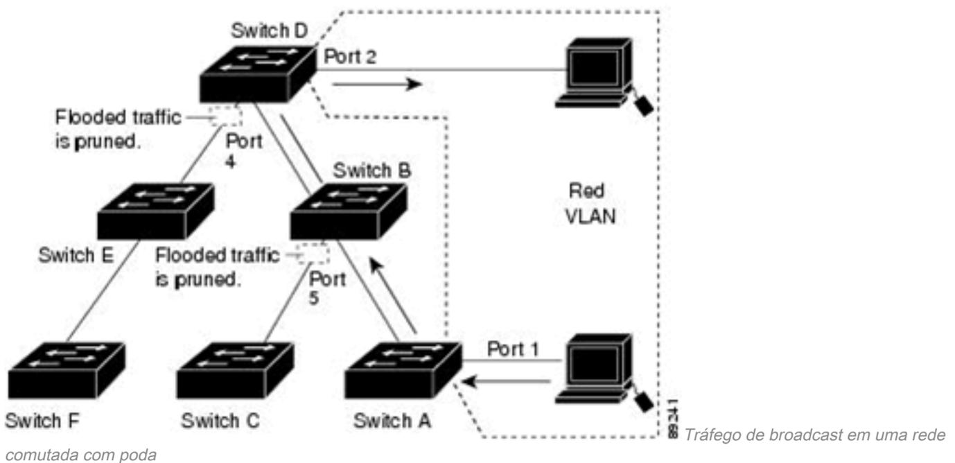
Esta figura mostra a mesma rede comutada com a poda de VTP permitida. O tráfego de broadcast do Interruptor A não é enviado aos Interruptores C, E, e F porque o tráfego para o VLAN vermelho foi podado nos links mostrados (porta 5 no interruptor B e porta 4 no interruptor D).
