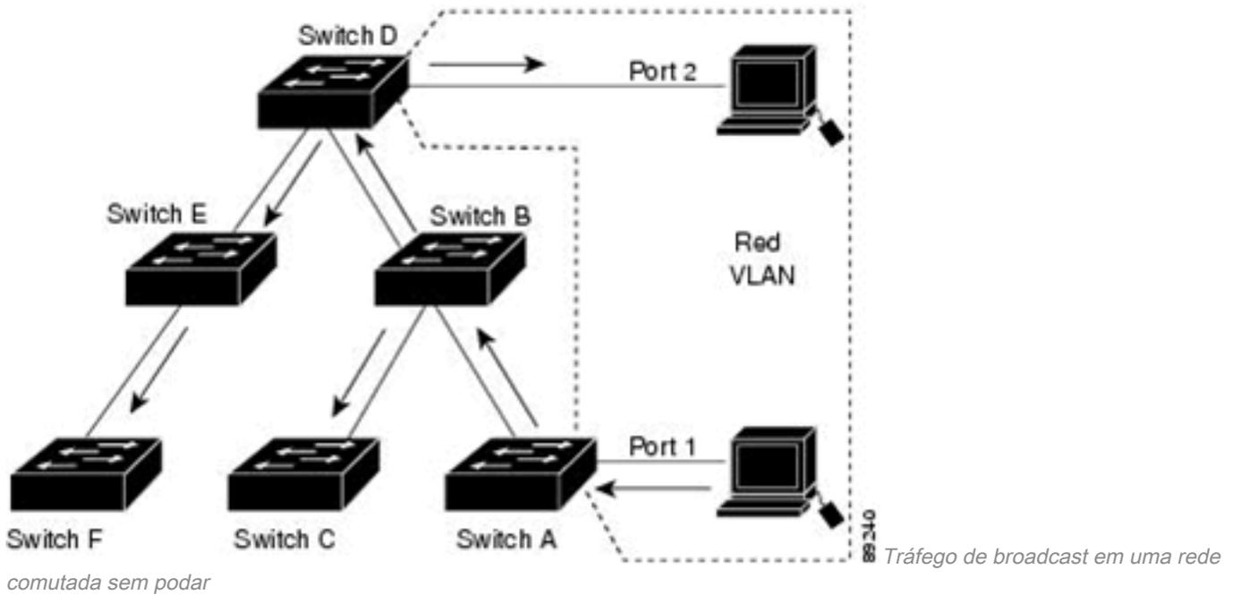
Esta figura mostra uma rede comutada sem poda de VTP permitida. A porta 1 no Interruptor A e a porta 2 no interruptor D são atribuídas ao VLAN vermelho. Se uma transmissão é enviada do host conectado ao Switch A, o Switch A inunda a transmissão e cada interruptor na rede recebe-a, mesmo que Interruptores C, E, e F não tenham nenhuma porta no VLAN vermelho.
