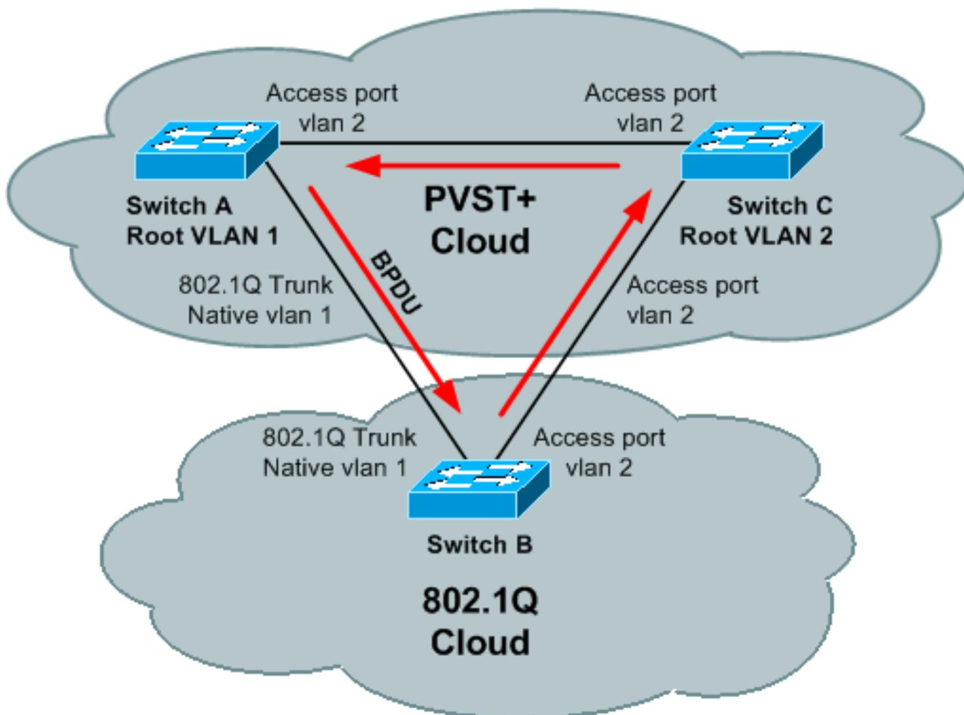
Se a BPDU da raiz na VLAN 1 for melhor que a BPDU da raiz na VLAN 2, não haverá porta de bloqueio na topologia da VLAN 2. A BPDU da VLAN 2 nunca faz um "círculo completo" em torno da topologia; ela é substituída pela BPDU da VLAN 1 no link B-C, porque B executa somente um
