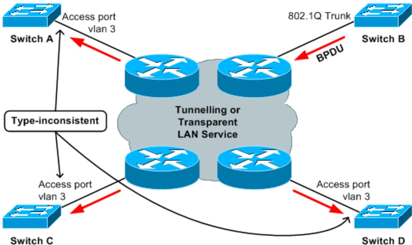
Neste exemplo, o switch B está configurado incorretamente e injeta um BPDU SSTP na nuvem. Isso faz com que as portas nos switches A, C e D se tornem de tipo inconsistente. O problema é que o dispositivo que origina a BPDU "ofensiva" não está diretamente conectado aos switches afetados. Assim, com muitos dispositivos no tronco, pode consumir tempo para solucionar todos eles.
