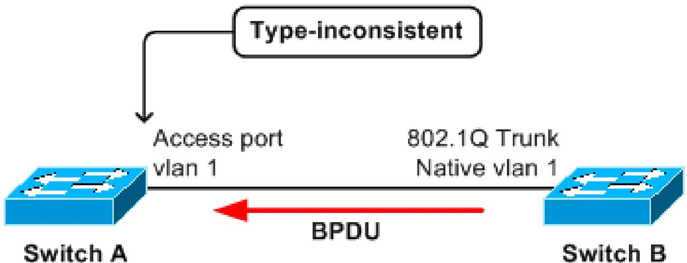
Neste cenário, a porta de acesso na ponte A recebe, da ponte B, um PVST+ BPDU marcado do STP de uma VLAN diferente de 1. A porta em A pode ser colocada em um estado de tipo inconsistente.
