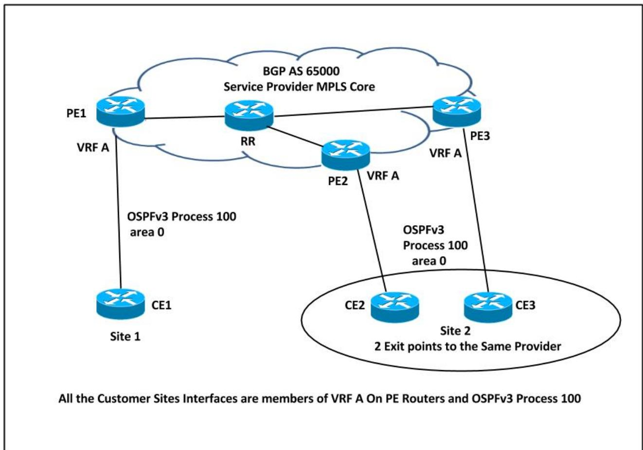
Nessa configuração, há uma possibilidade de um loop. Por exemplo, se CE1 anunciar o LSA Tipo
