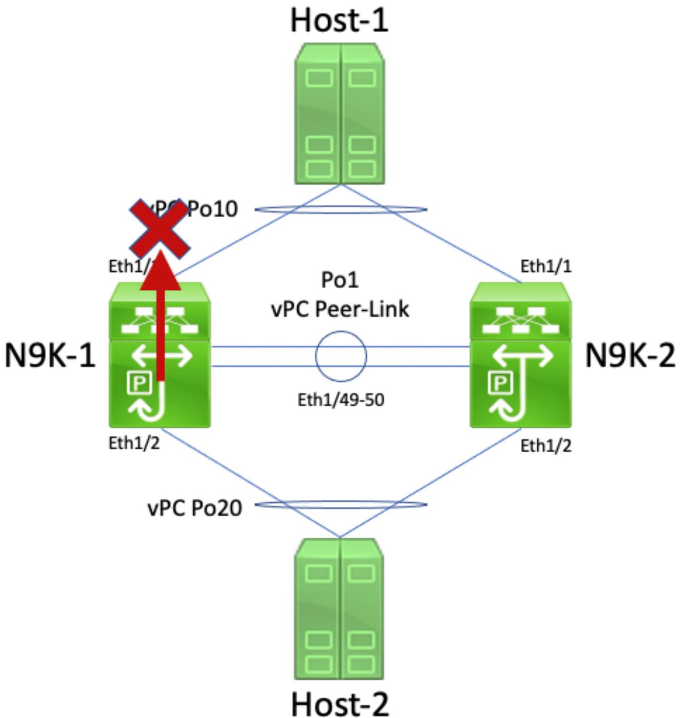
Você pode resolver esse problema ativando o aprimoramento vPC Peer Gateway com o comando de configuração de domínio de vPC peer-gateway. Isso permite que o N9K-2 encaminhe o pacote de resposta de ICMP (e outros pacotes endereçados de forma semelhante) em nome do N9K-1, mesmo que o endereço MAC de destino do pacote pertença ao N9K-1 e não ao N9K-2. Como resultado, o N9K-2 pode encaminhar esse pacote da interface do Po10 de vPC, em vez de encaminhá-lo pelo vPC Peer-Link.
