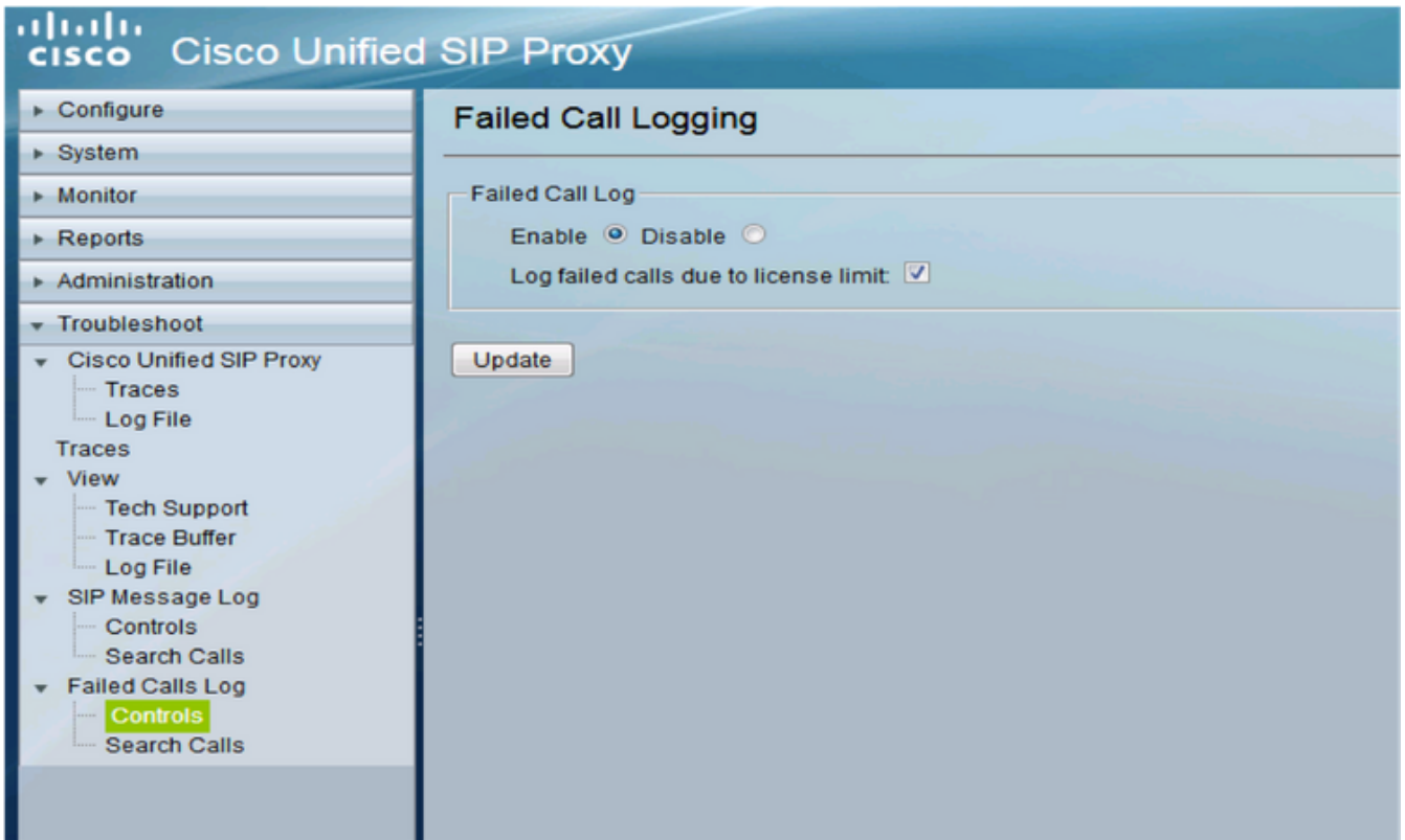
Ativar registro de chamada com falha
